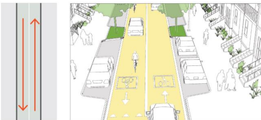
Slika 26 Smirenje prometa pomoću dvosmjernih prometnica
