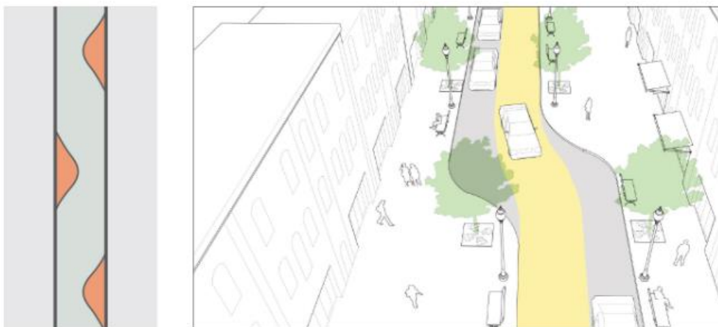
Slika 25 Smirenje prometa pomoću šikana i promjene traka za prometovanje
