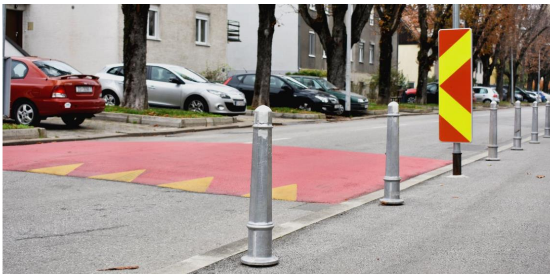
Slika 20 Primjer cestovnog uspornika - Zagreb, Hrvatska
