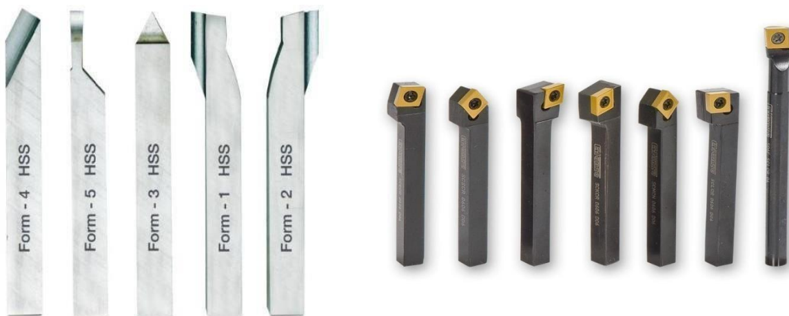
Slika 8.1 Alati iz jednog komada od brzoreznog čelika (lijevo) i alati sa zamjenjivim reznim pločicama [12]
