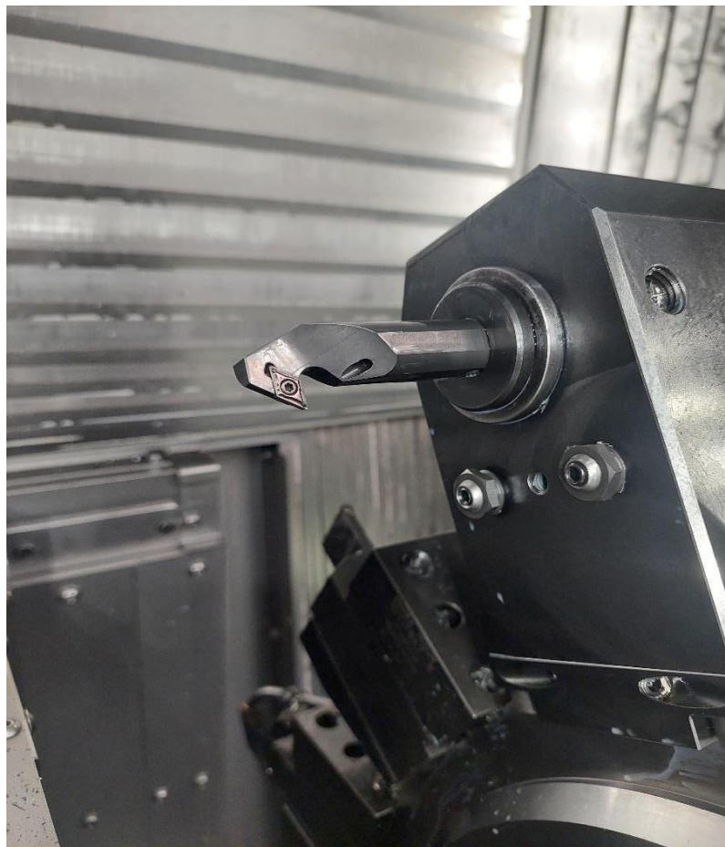
Slika 6.6 Adapter 570-SDUCR-20-07-EX i pločica DCMT 07 02 04-PF 4415
