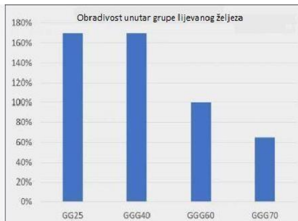
Slika 5.11 Usporedba obradivosti između sivog lijeva (GG-25) i nodularnog [9]
