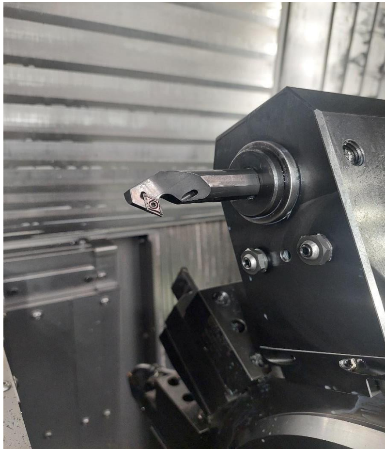
Slika 6.6 Adapter 570-SDUCR-20-07-EX i pločica DCMT 07 02 04-PF 4415
