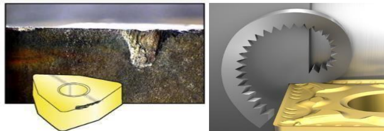
Slika 9.23 Udaranje strugotine u reznju oštricu [10]
