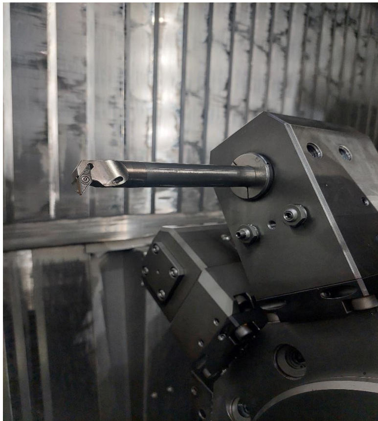
Slika 6.5 Držač „A12M-SDXCR 07-R“ i pločica „DCMT 07 02 08-UM 4425“
