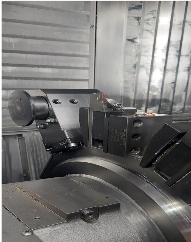
Slika 6.8 Držač „570-DVUNL-40-16“ i pločica „VNMG 16 04 08-MM 1125“
