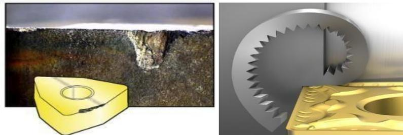
*Slika 9.23 Udaranje strugotine u reznu oštricu [10]*
