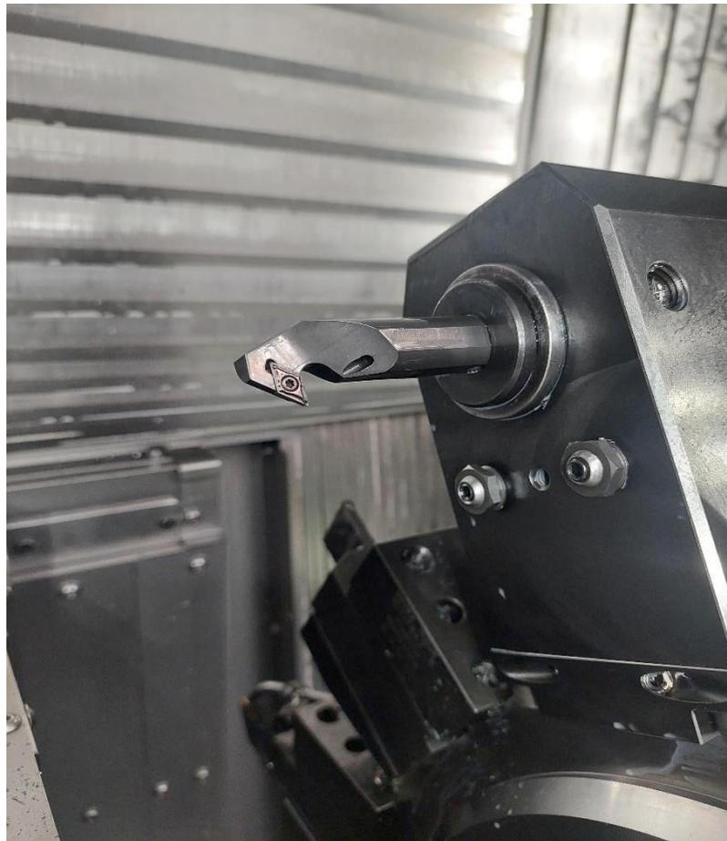
Slika 6.6 Adapter 570-SDUCR-20-07-EX i pločica DCMT 07 02 04-PF 4415
