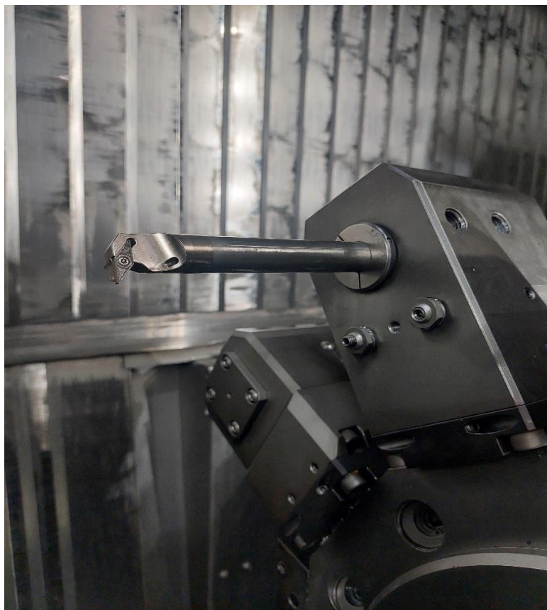
Slika 6.5 Držač „A12M-SDXCR 07-R“ i pločica „DCMT 07 02 08-UM 4425“
