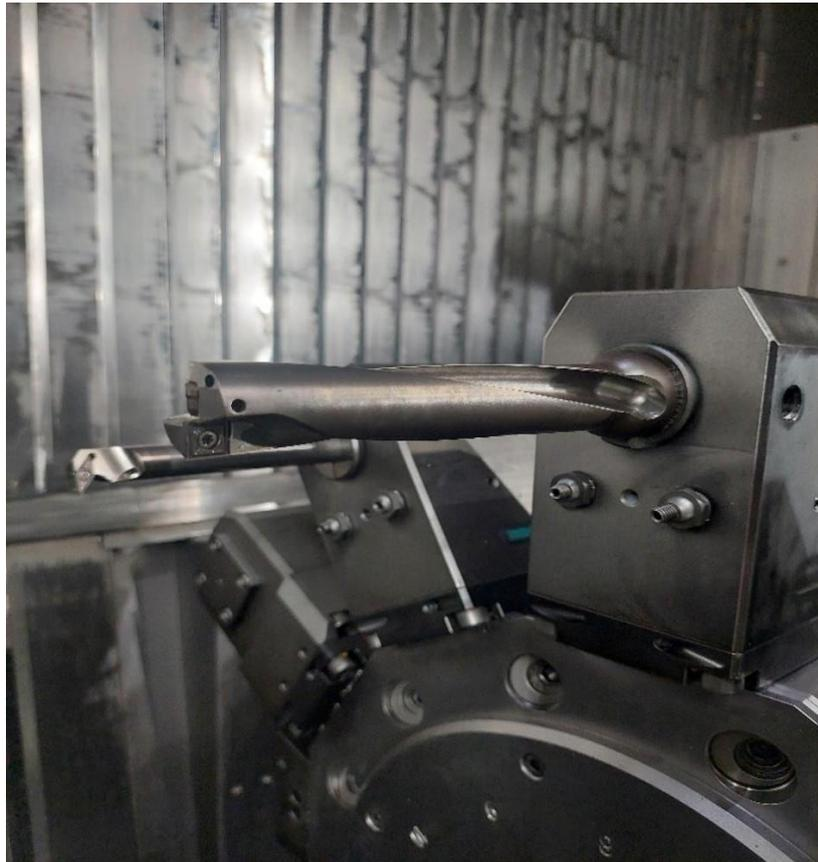
Slika 6.4 Držač, obodna i centralna pločica za bušenje
