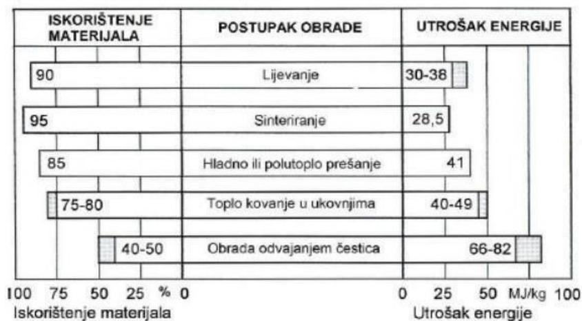
Slika 5.3 Iskorištenje materijala kod pojedinih postupaka obrade [6]
