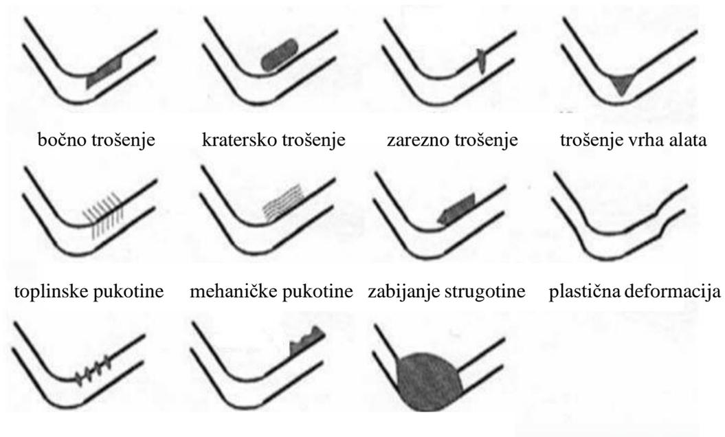
Slika 9.16 Oblici trošenja alata [15]
