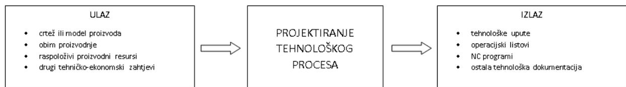
*Slika 4.1 Ulazni i izlazni rezultati projektiranja tehnološkog procesa [2]*
