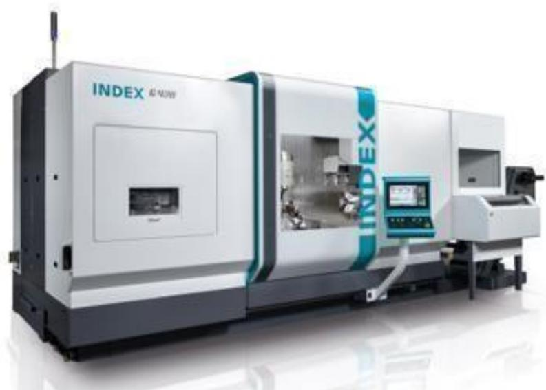
*Slika 7.1 Tokarsko-glodaći obradni centar INDEX G420 [11]*
