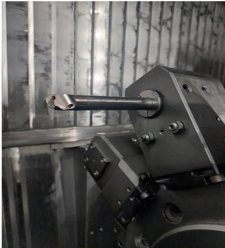
*Slika 6.5 Držač „A12M-SDXCR 07-R“ i pločica „DCMT 07 02 08-UM 4425“*
