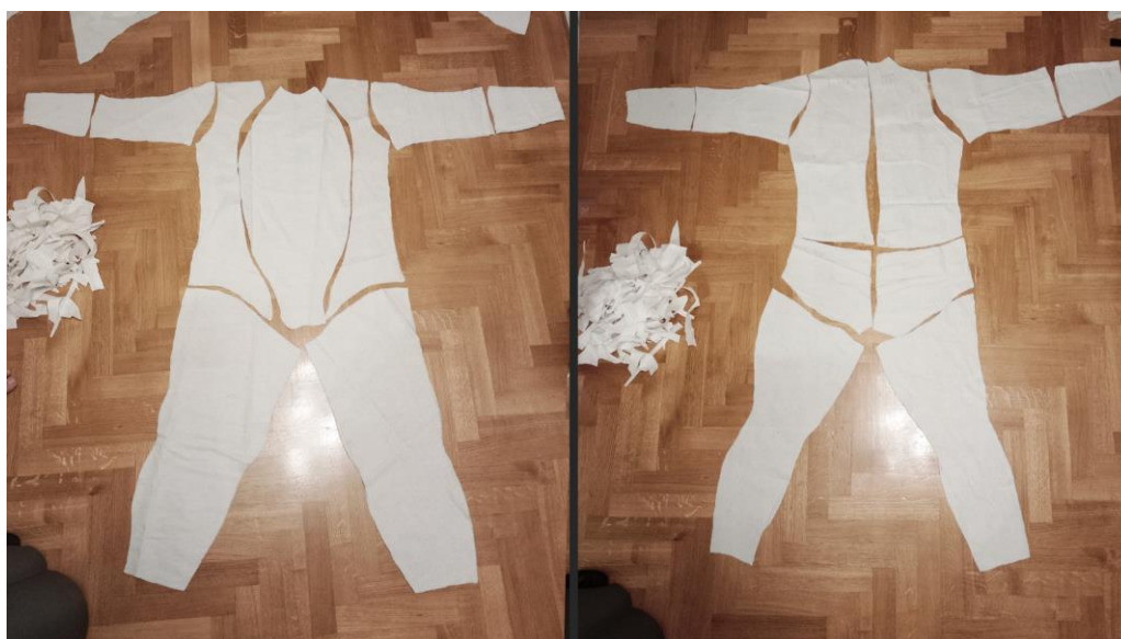
Slika 38. Dobiveni kroj modela na komadu povoljne tkanine, Autor
