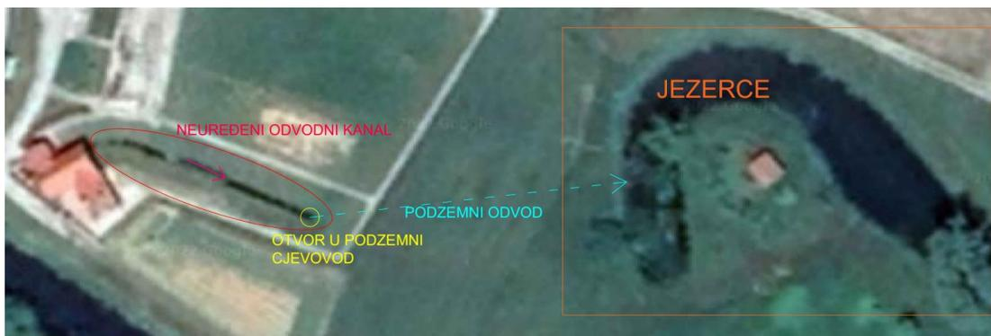
*Slika 31. Shematski prikaz odvodnje vode od vodnog kola do jezera [22]*
