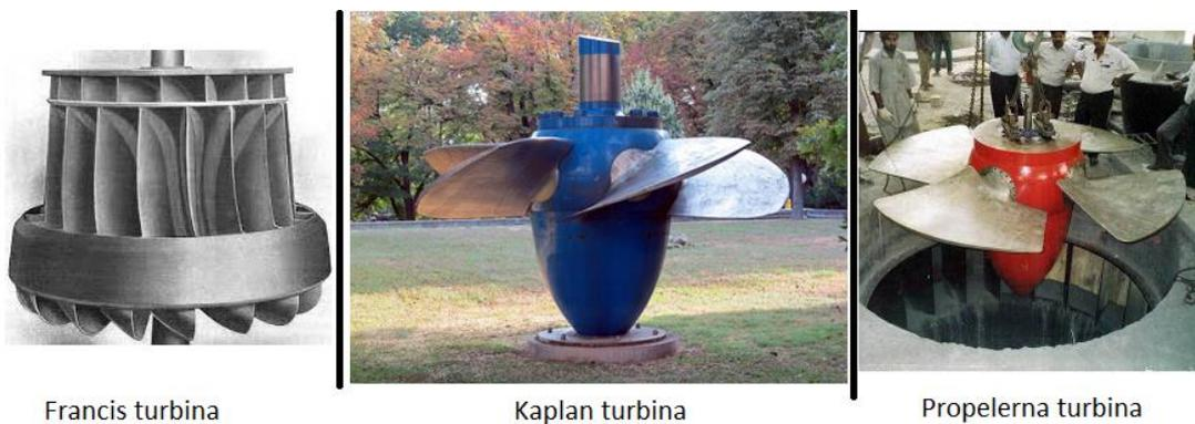
Slika 2. Vrste reakcijskih turbina [3]
