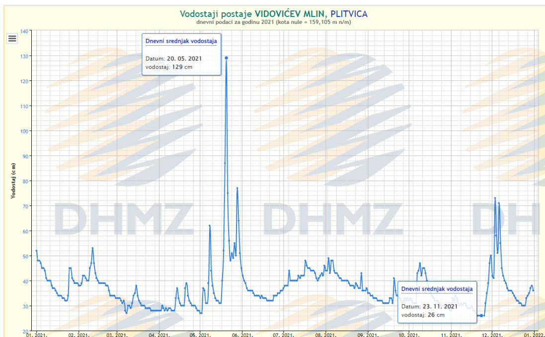
Slika 20. Nivogram – Mjerna postaja: Vidovičev mlin [8]
