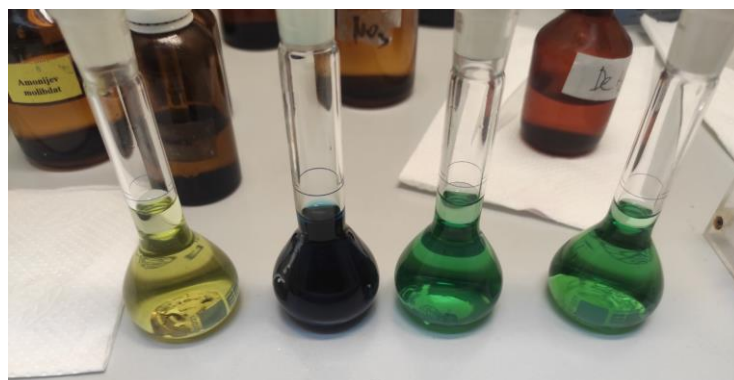
Slika 4.16. Rezultat određivanja amonijaka
