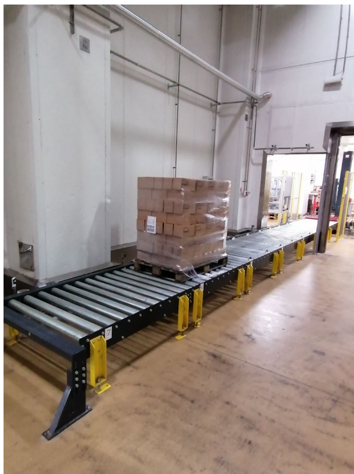
Slika 16. Valjkasti transporteri na kojima dolazi roba iz proizvodnje u SGR
