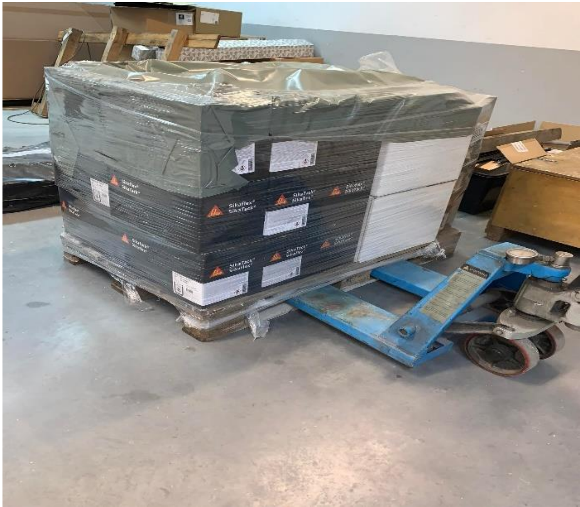
Slika 2.7. Upotreba ručnog viličara u procesu unutarnjeg transporta
