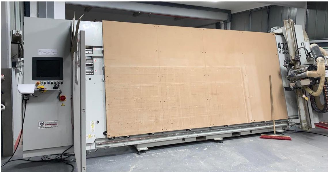
Slika 3.4. Stroj za obradu ploča za ventilirane fasade
