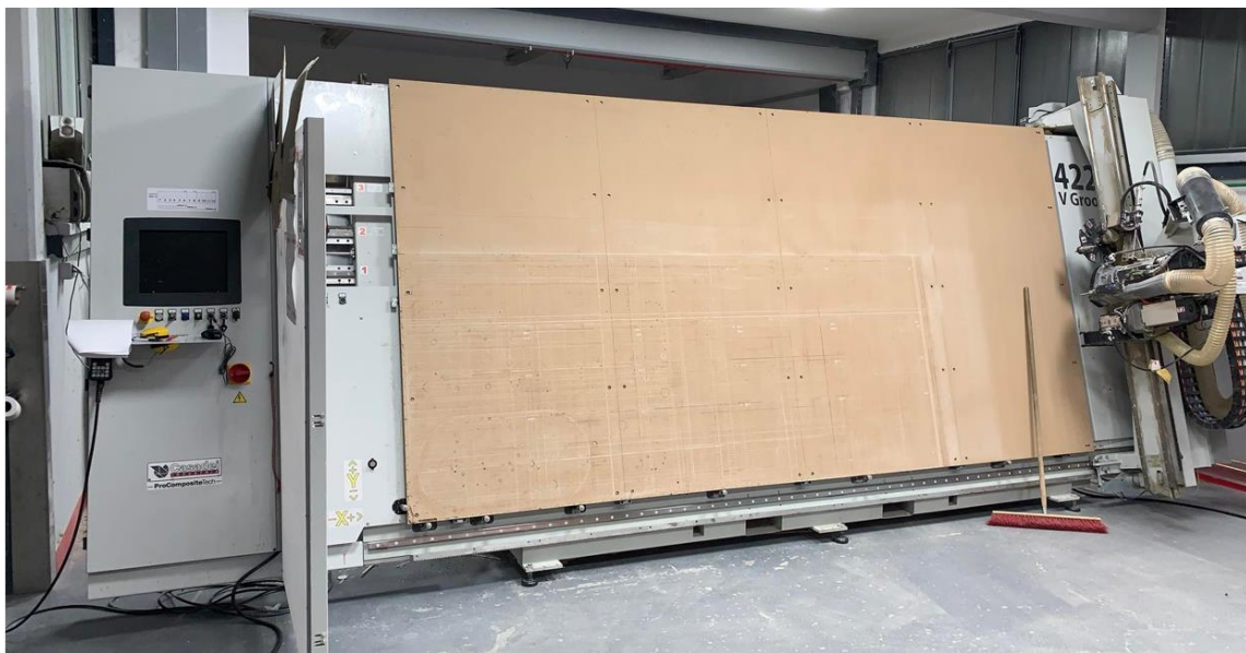
Slika 3.4. Stroj za obradu ploča za ventilirane fasade
