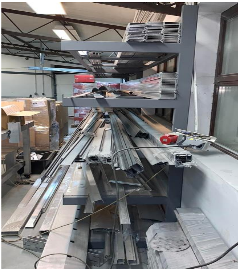
Slika 2.5. Bočni prikaz konzolnog regala sa aluminijским profilima
