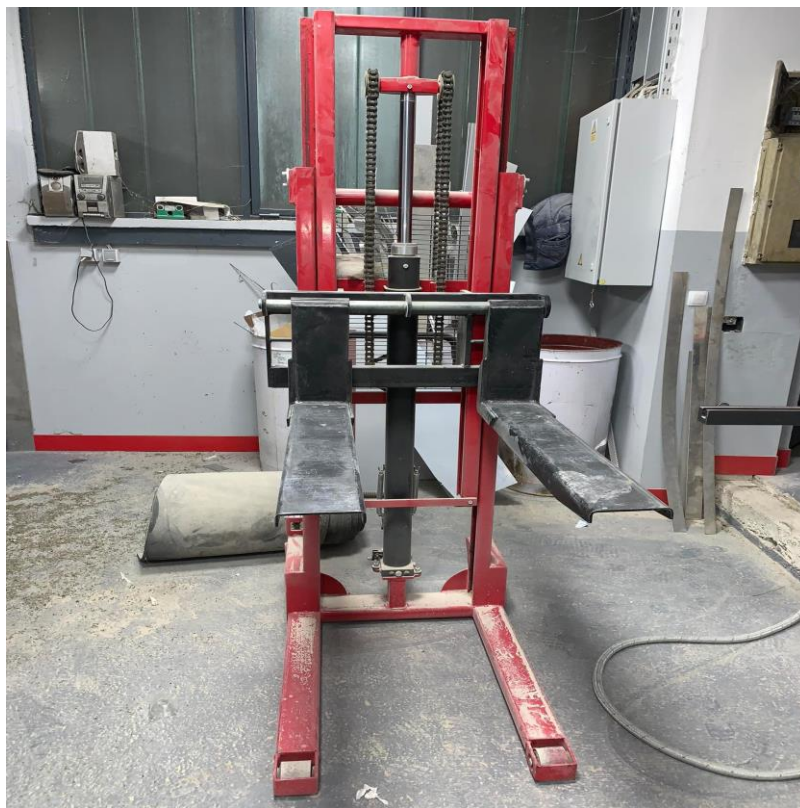
Slika 2.6. Ručni visoko podizni viličar
