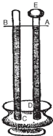
Slika 1. Torricelijev eksperiment s vakuumom. [1]
