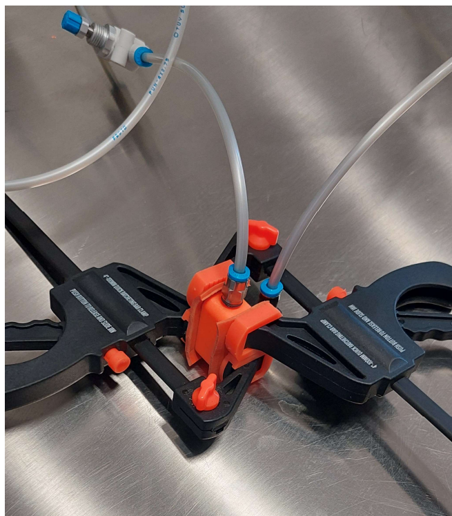
Slika 21. Prikaz brtvljenja vakuum generatora
