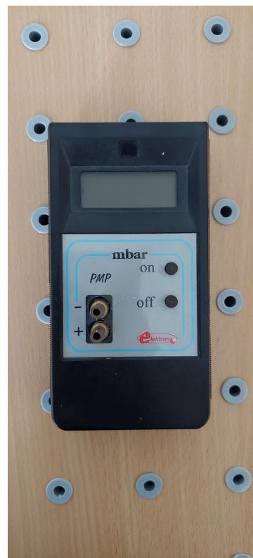
Slika 24. Precizni mjerač pritiska
