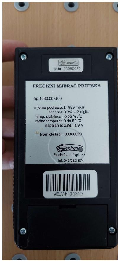
Slika 25. Karakteristike preciznog mjerača pritiska
