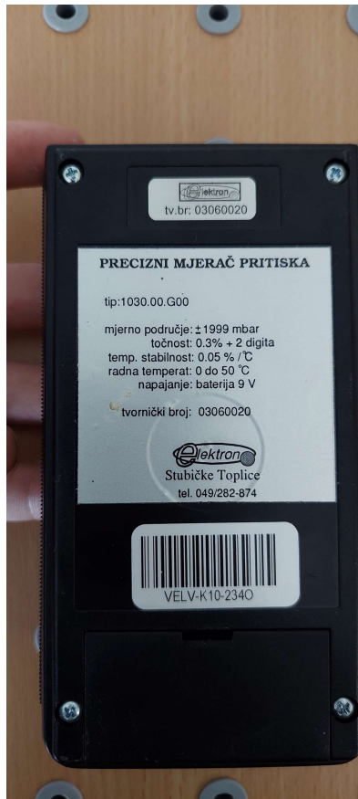
Slika 25. Karakteristike preciznog mjerača pritiska
