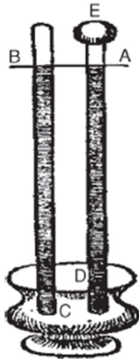
Slika 1. Torricelijev eksperiment s vakuumom. [1]
