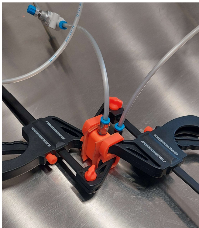
Slika 21. Prikaz brtvljenja vakuum generatora
