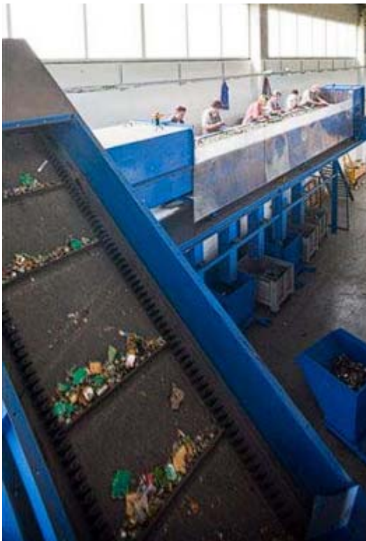
Slika 23. Prikaza usitenjog EE otpada na traci [34]
