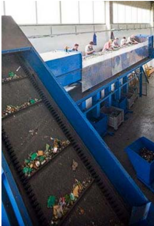
Slika 23. Prikaza usitenjog EE otpada na traci [34]
