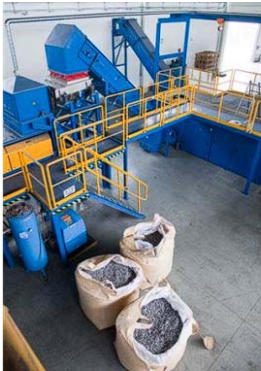
Slika 24. EDDY strujni separator [34]
