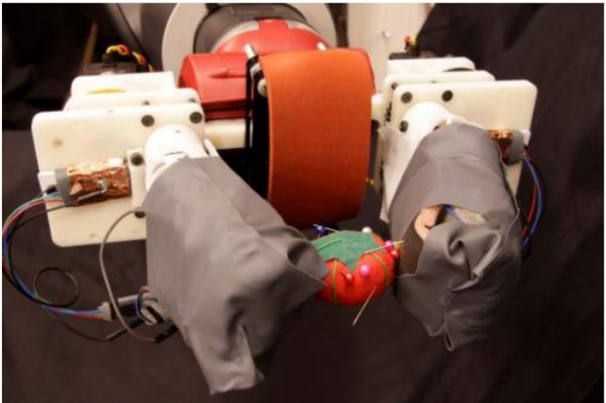
Slika 21. Demonstracija klasifikacije materijala opipom [33]
