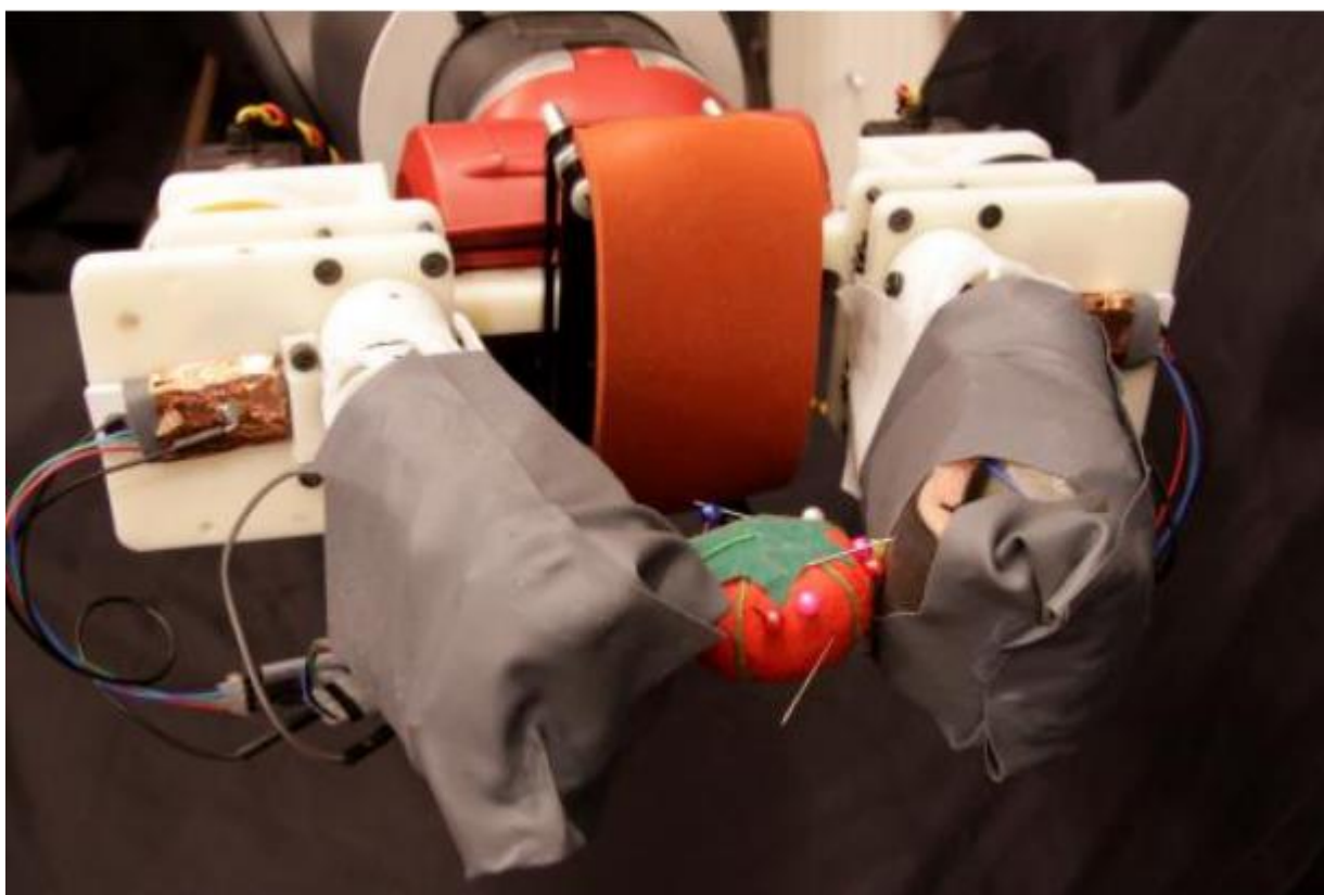
Slika 21. Demonstracija klasifikacije materijala opipom [33]
