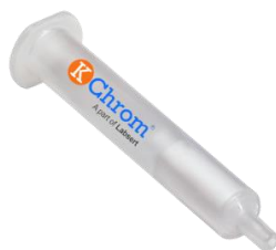
Slika 4: Primjer SPE kolone. Izvor: www.labsertchemical.com
