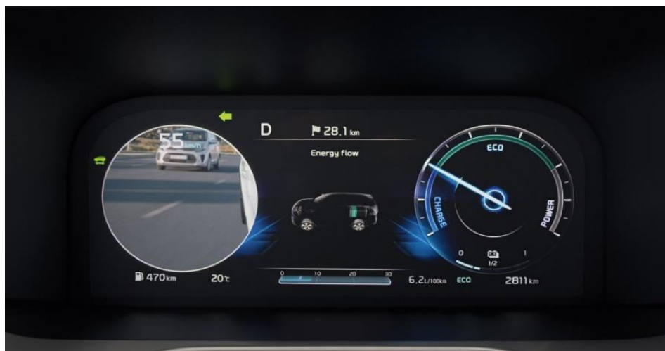
Slika 6 Prikaz pomoći za vozačev mrtvi kut
