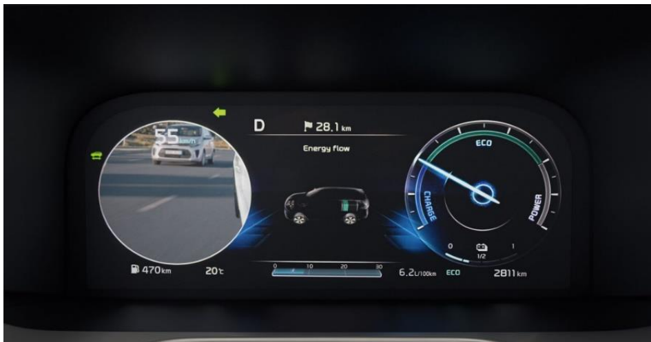
Slika 6 Prikaz pomoći za vozačev mrtvi kut
