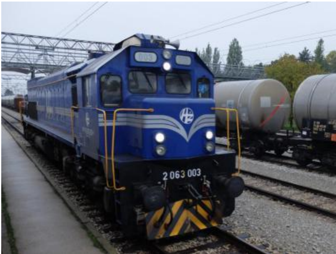
Slika.21: Dizel električno vozilo serije 2063
