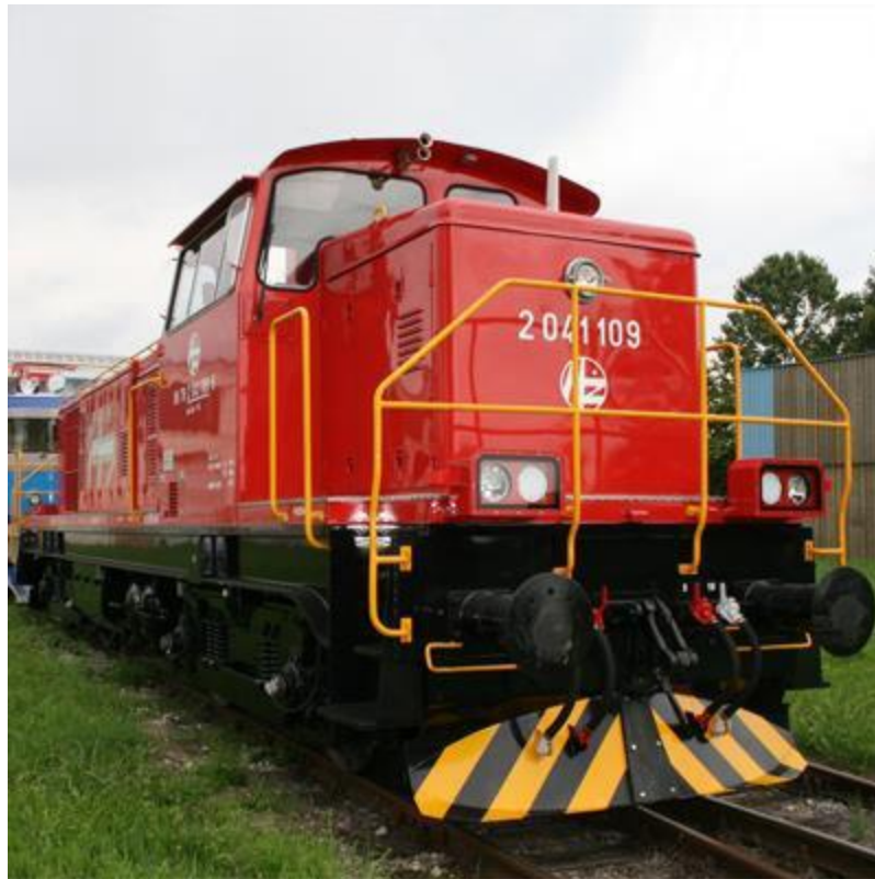
Slika.18.:Dizel električna lokomotiva serije 2041-100
