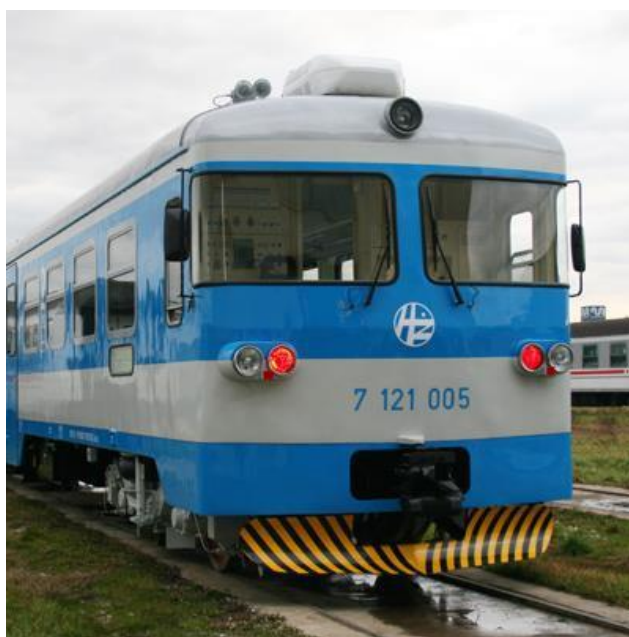
Slika.9: Dizel motorni vlak serije 7121
