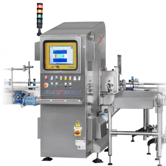
Slika 6. X-ray Uređaj za kontrolu stranih tijela u namirnicama.
