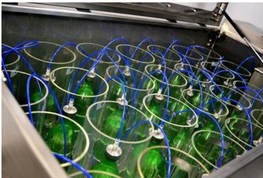
Slika 13. Crack test PET boca [Izvor: Martin Božurić]
