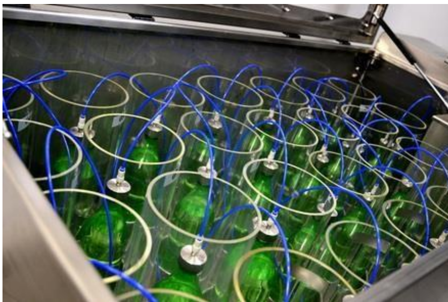
Slika 13. Crack test PET boca [Izvor: Martin Božurić]
