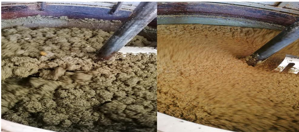
Slika 3.2.4. pečenje usitnjenih bučinih koštica, izvor: autor
