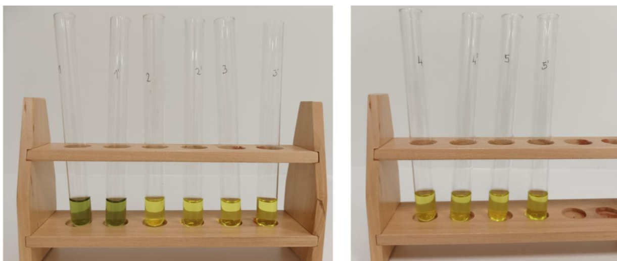
Slika 3.3. Uzorci otopina meda pomiješana s 10 %-tnim Folin-Ciocalteu reagensom, izvor: Autor
