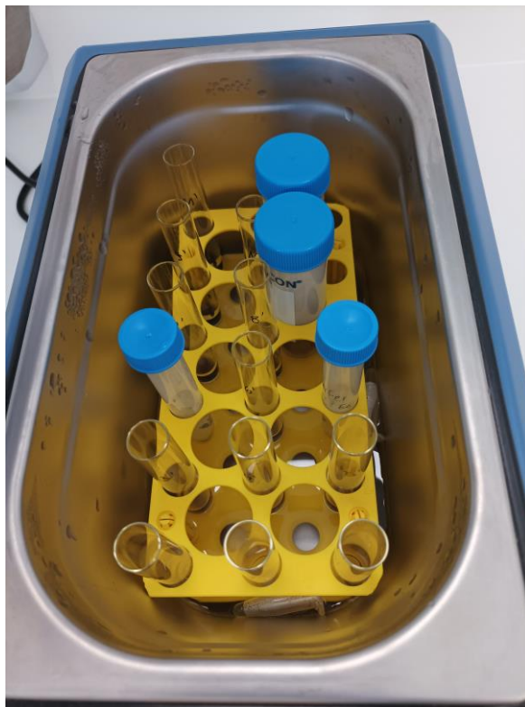
Slika 3.6. Uzorci tijekom termostatiranja u vodenoj kupelji, izvor: Autor
