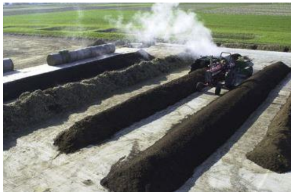
Slika 4. Windrow sustav kompostiranja [18]
