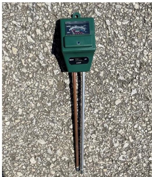
Slika 19. Mjerač vlage i pH vrijednosti (Izvor: autor)
