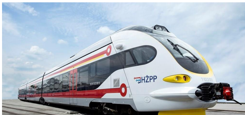
Slika 11. Niskopodni dizel-motorni vlak serije 7 023
