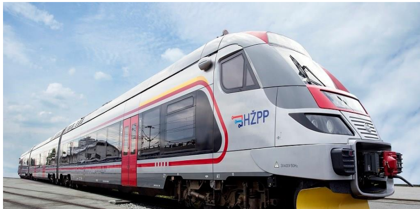
Slika 10. Niskopodni dizel-motorni vlak serije 7 022
