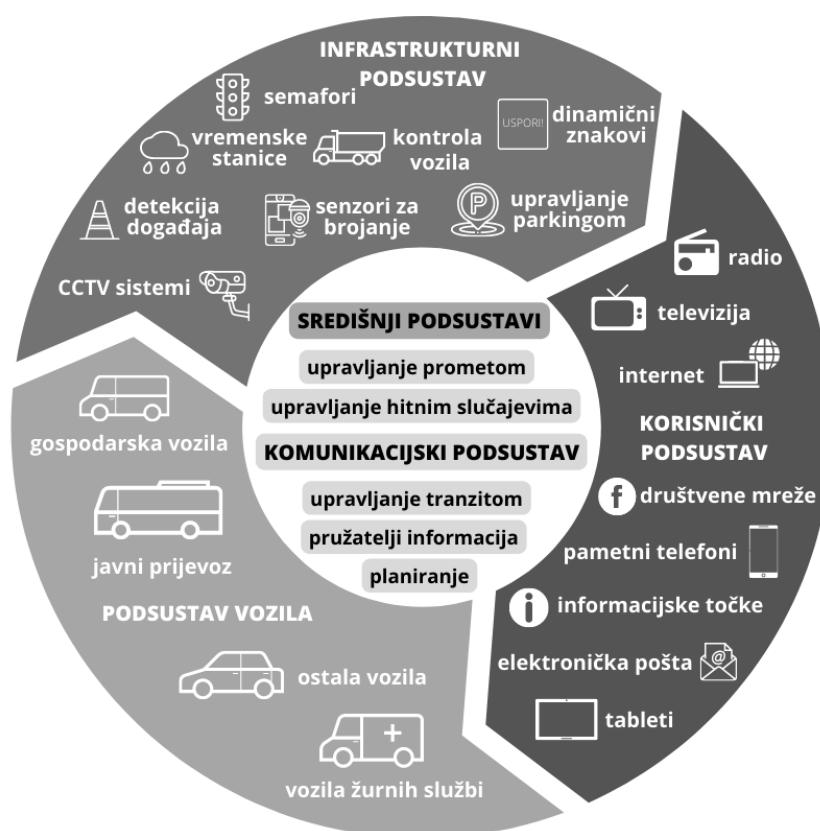
Slika 1. Konceptualni model inteligentnih transportnih sustava
