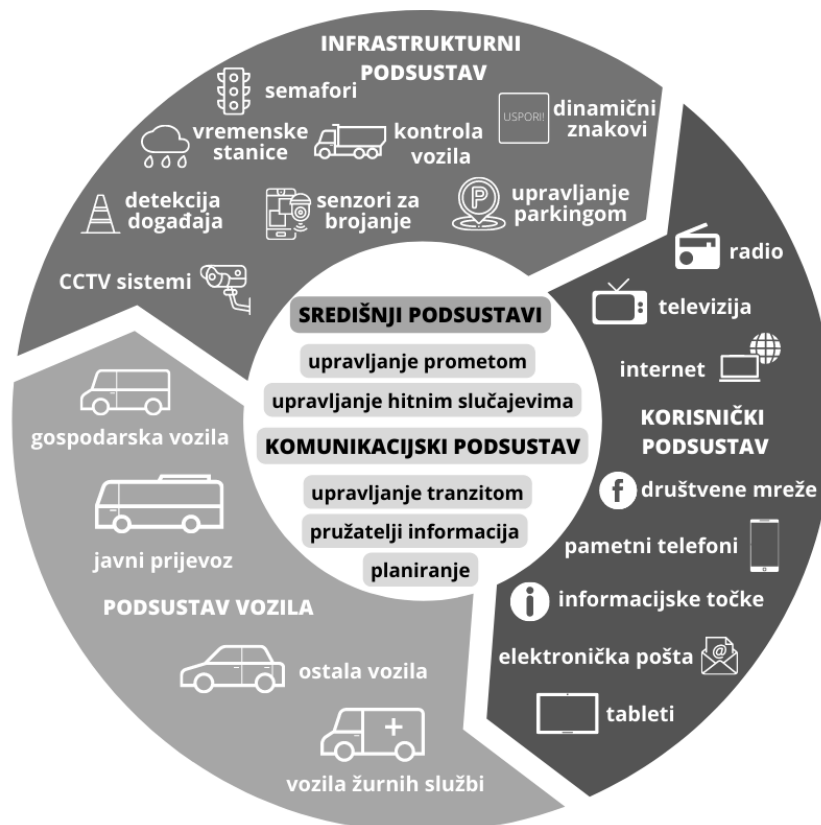
Slika 1. Konceptualni model inteligentnih transportnih sustava
