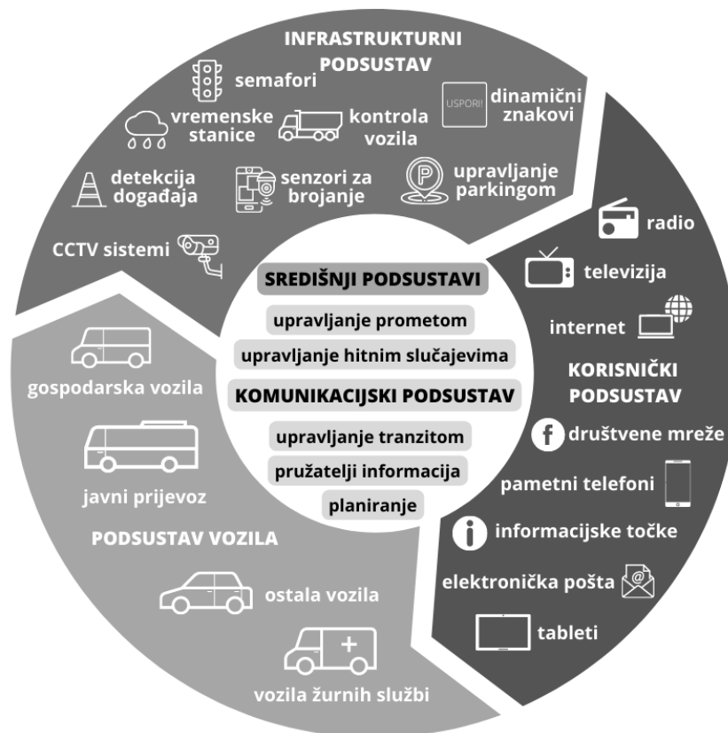
Slika 1. Konceptualni model inteligentnih transportnih sustava
