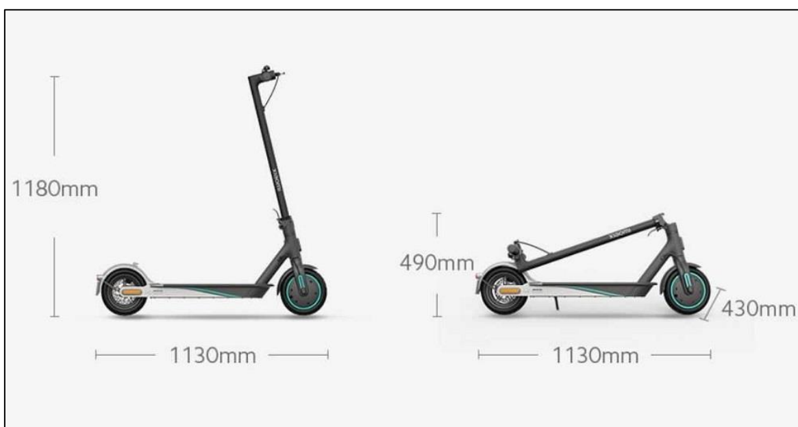
Slika 4.1. Dimenzije standardnog električnog romobila
