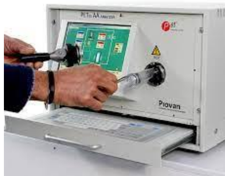
Slika 7-10: Uređaj za mjerenje acetaldehida u predobliku (Izvor: https://spectraservices.com/category/spectrophotometers.html )
