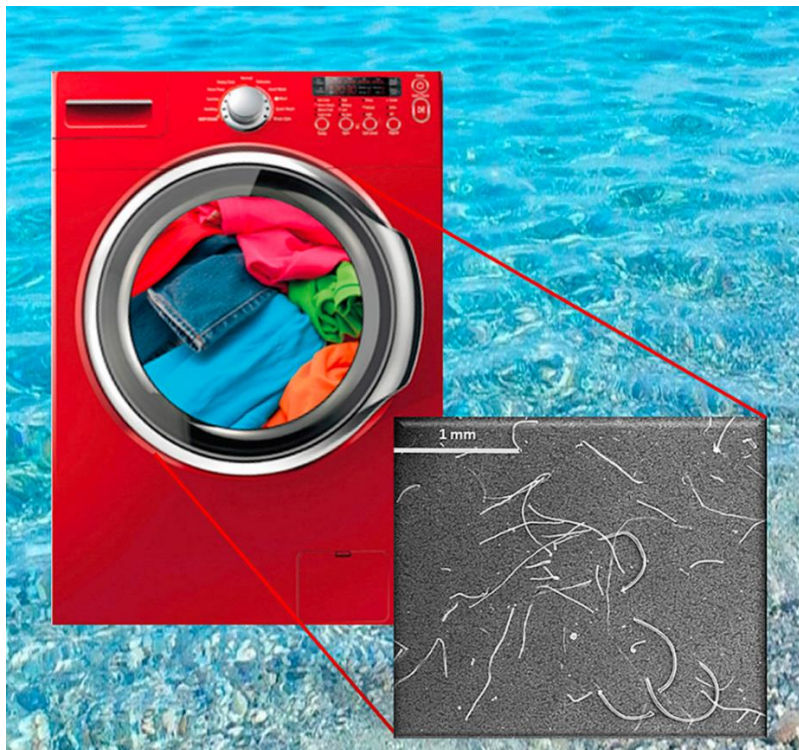
Slika 11. Mikroskopska slika mikrovlakana u otpadnoj vodi nastaloj pranjem sintetičke odjeće
