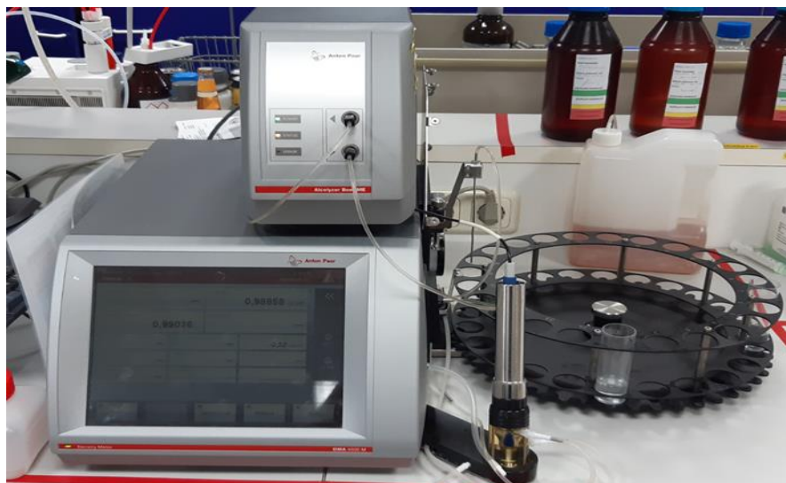
Slika 7.3 Analizator gustoće, alkohola, pH i boje; Carlsberg Croatia; Anabela Škorjanec, kolovoz 2022.
