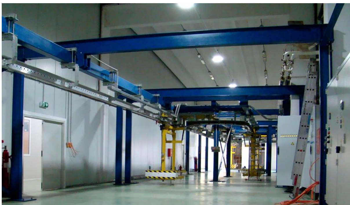
Slika 20 Vodilice koje robu od trakastih transporterata vode u ćelije i obratno
