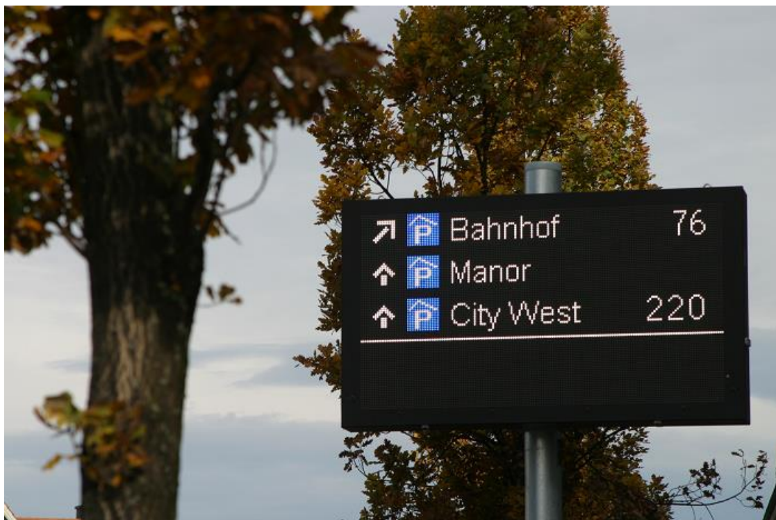
Slika 21. Sustav za navođenje parkiranja
