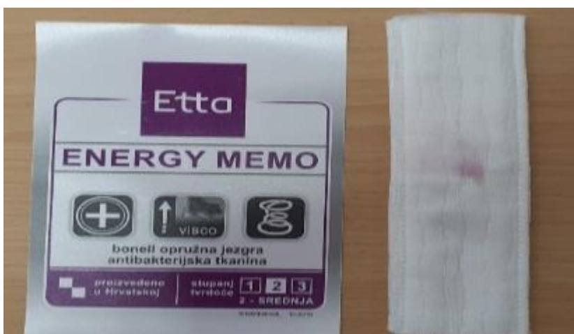
Slika 4.7.1 Primjer preslikavanja boje na platno [8]
