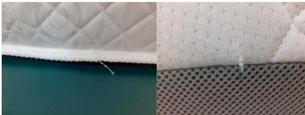
Slika 4.10.1 Primjer viška konca (lijevo) i izvučenog konca (desno) [8]
