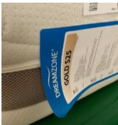
Slika 4.7.2 Primjer lošeg prijanjanja etikete [8]
