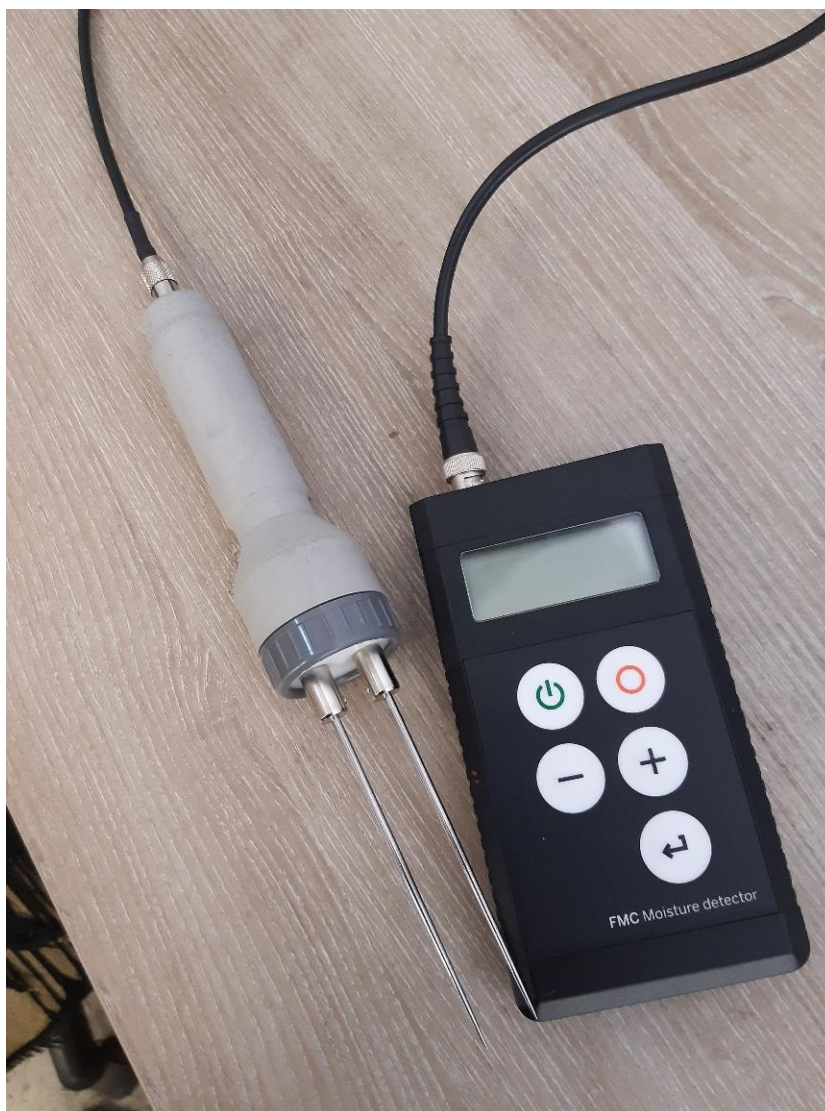
Slika 4.9.1 Uređaj za mjerenje vlage [autor]
