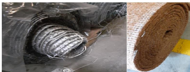
Slika 4.2.1 Primjer neispravno namotane bale filca (lijevo) i ispravno namotane bale kokosa (desno) [8]
