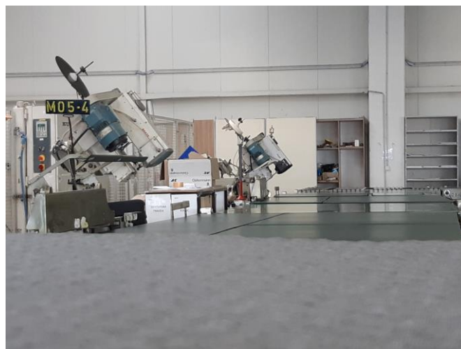
Slika 2.1.6 Tape edge šivaće mašine [autor]
