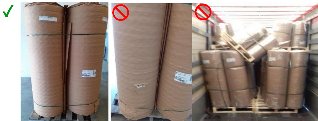
Slika 3.1.1 Primjer ispravne i oštećene ambalaže [8]
