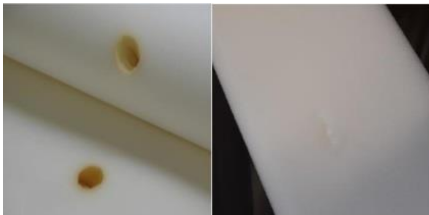
Slika 4.1.2 Primjer neispunjenosti materijala [8]
