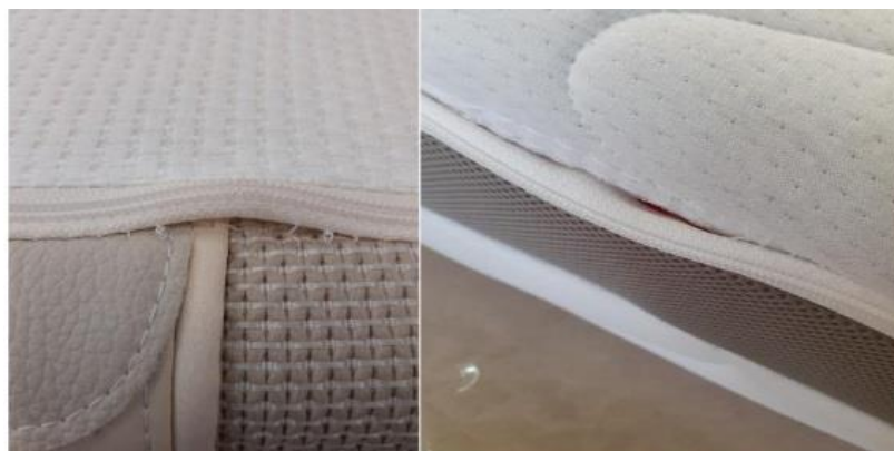
Slika 4.10.3 Primjer neispravnih šavova [8]
