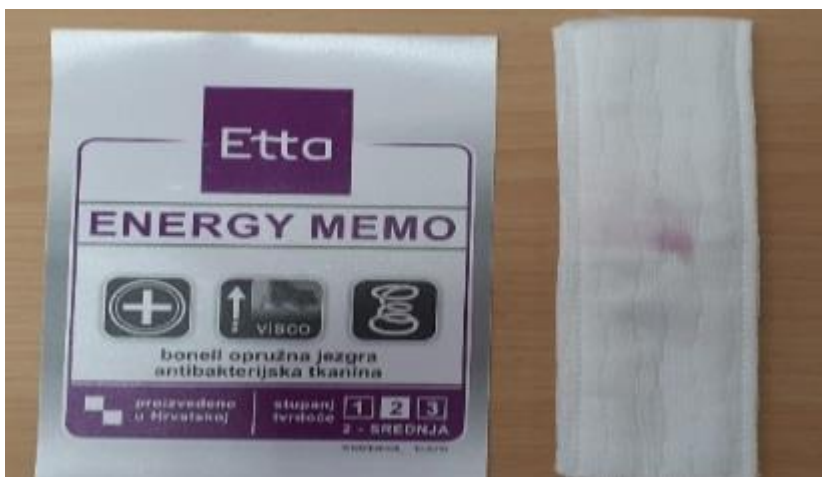
Slika 4.7.1 Primjer preslikavanja boje na platno [8]
