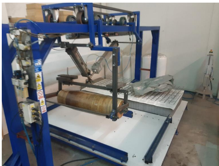
Slika 4.10.2.1 Stroj za valjanje madraca [autor]
