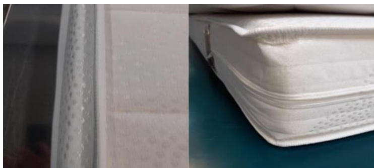
Slika 4.10.2 Primjer neusklađenosti navlake i rohlinga [8]
