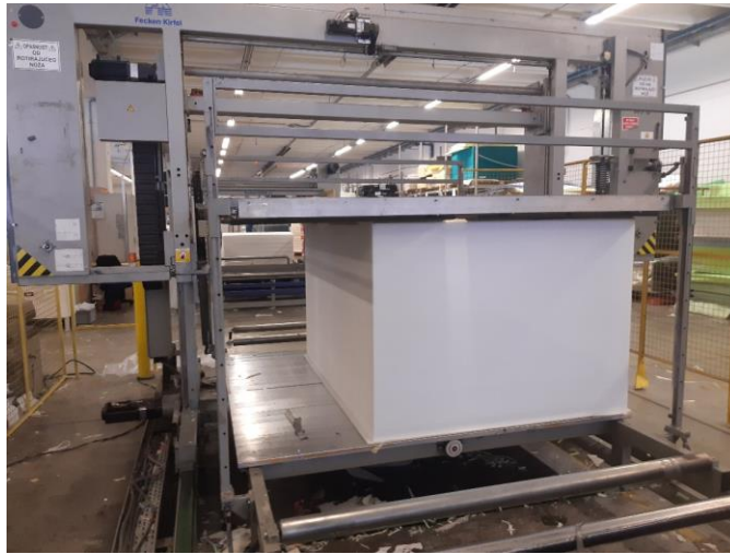
Slika 2.4.1 CNC profilirka [autor]
