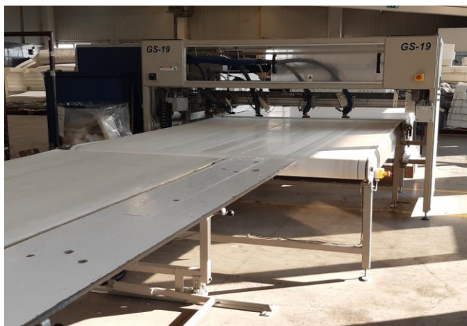
Slika 2.2. Linija za lijepljenje grijanim ljepilom [autor]
