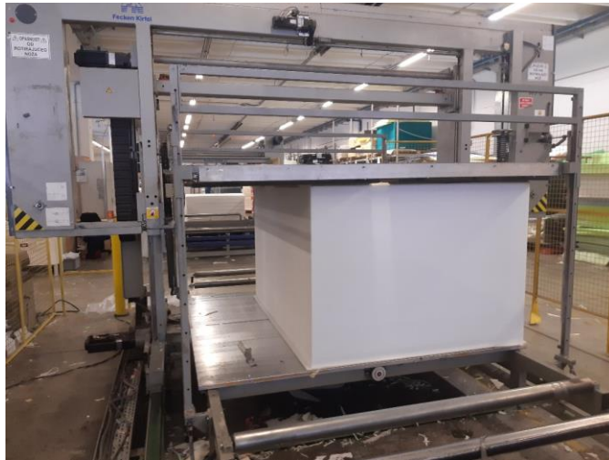
Slika 2.4.1 CNC profilirka [autor]
