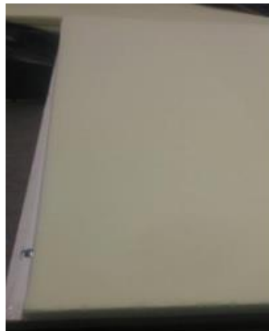
Slika 4.1.1 Primjer neispravno izrezane plohe [8]
