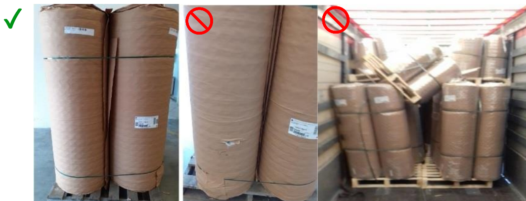
Slika 3.1.1 Primjer ispravne i oštećene ambalaže [8]
