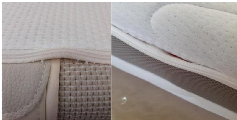
Slika 4.10.3 Primjer neispravnih šavova [8]
