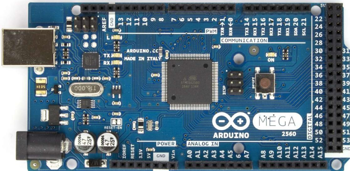
Slika 3.6. Arduino MEGA 2560 mikrokontroler [16]
