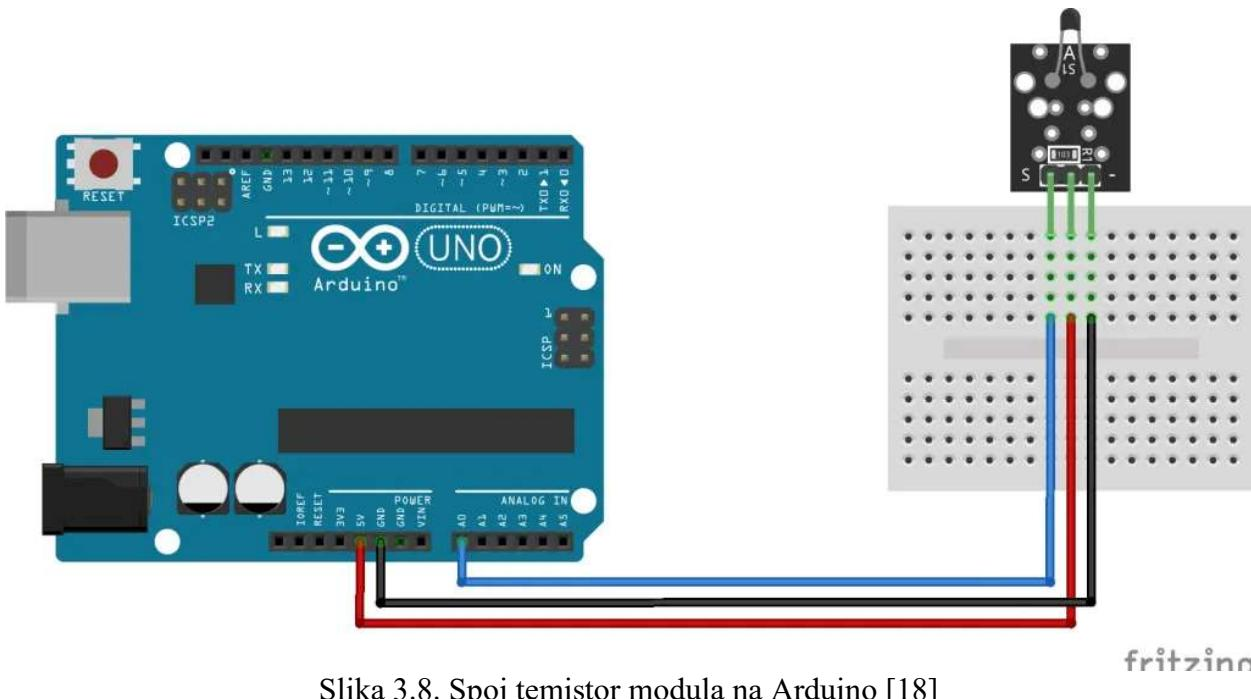
Slika 3.8. Spoj temistor modula na Arduino [18]
