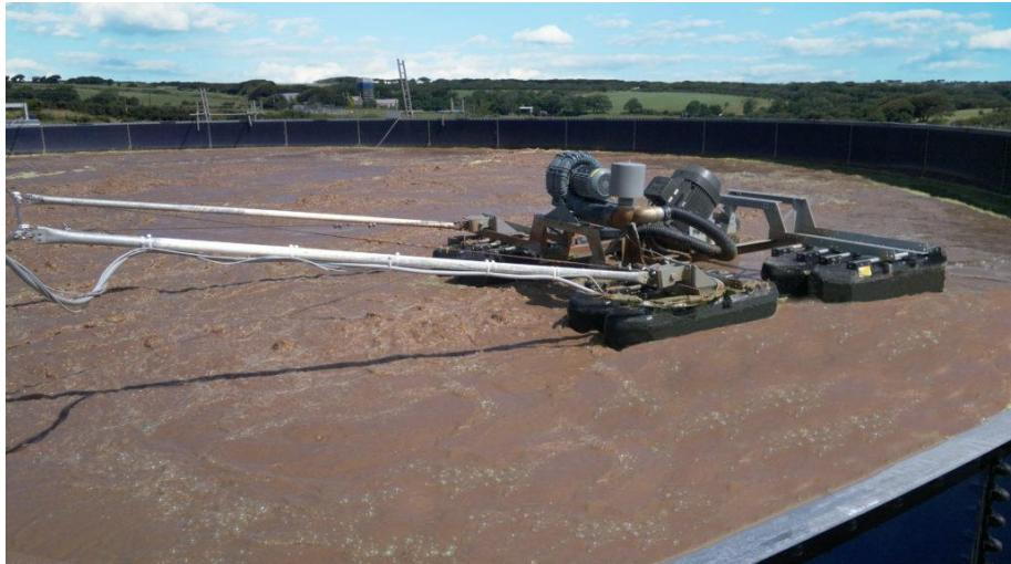
Slika 10: Aerobna digestija mulja [14]
