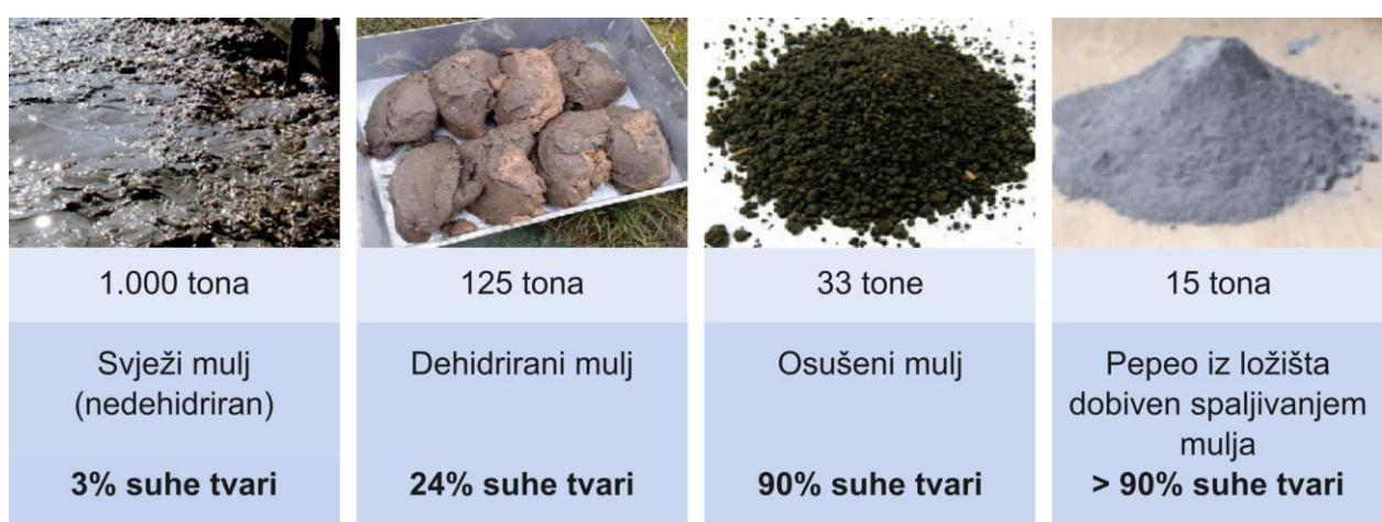
Slika 14: Smanjenje ukupne mase mulja ovisno o stupnju obrade [17]
