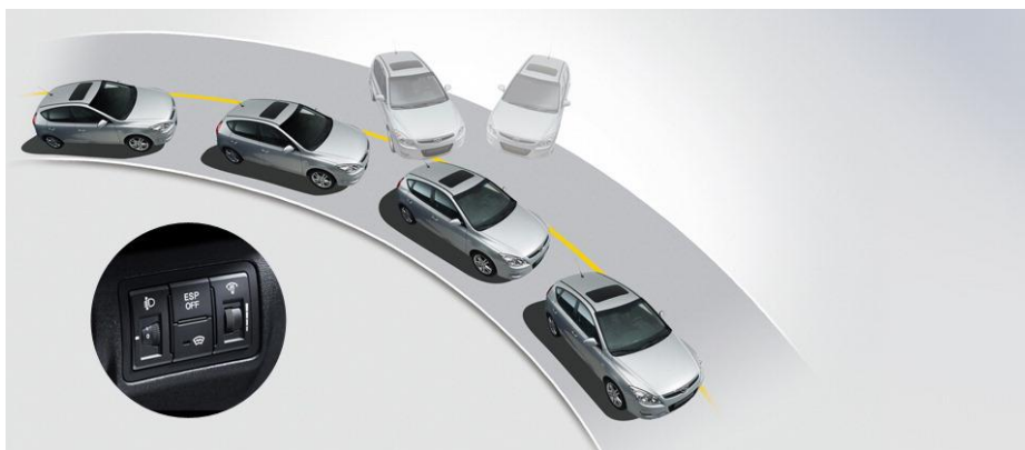
Slika 9: Funkcioniranje ESP sustava[10]
