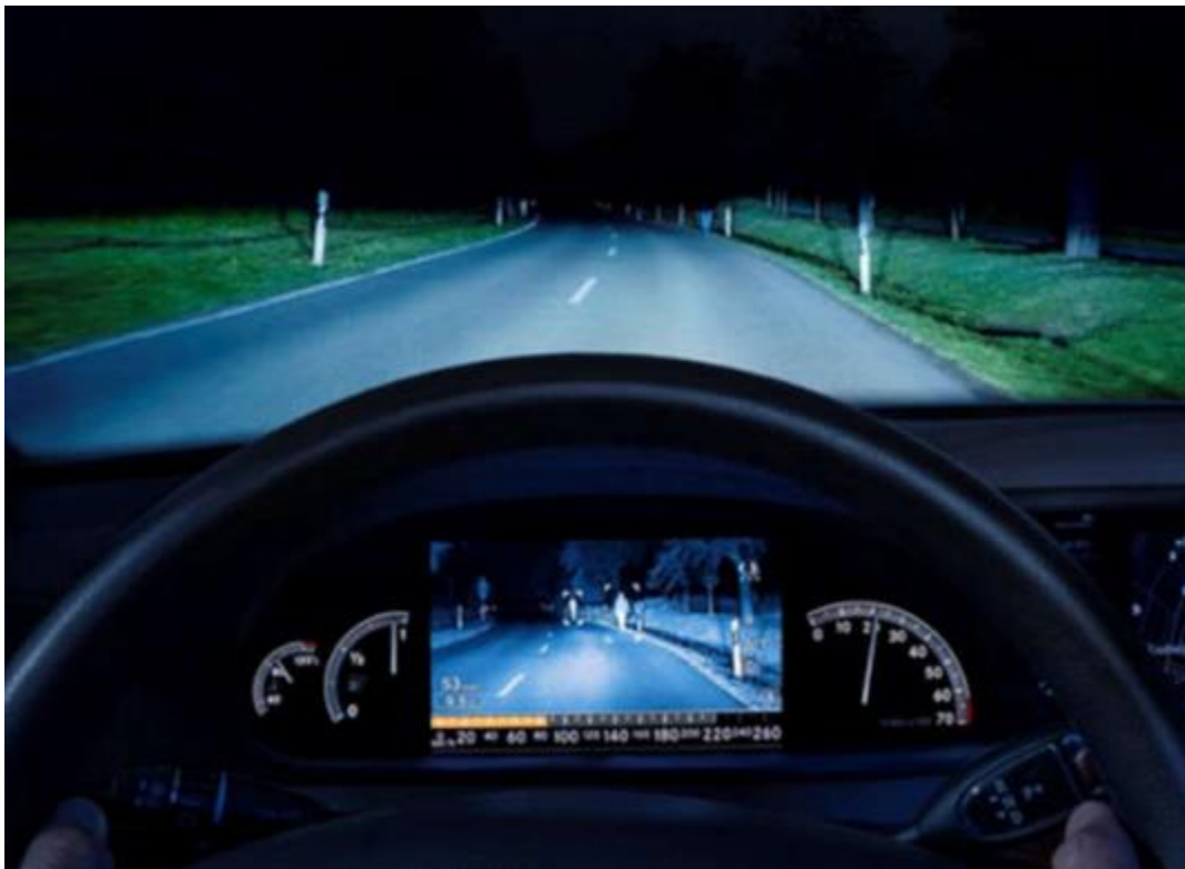
Slika 6. Infracrvena kamera za noćni vid u vozilu, izvor: [10]
