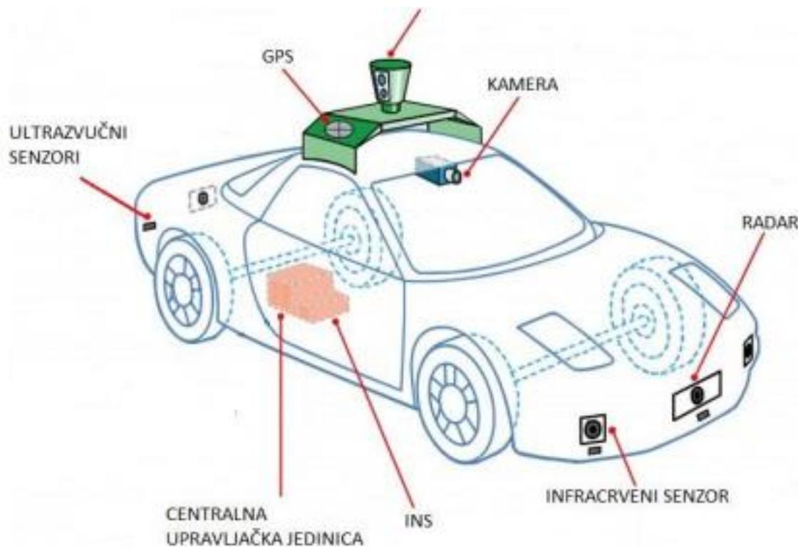
Slika 5. Sustav senzora prikazan na autonomnom vozilu, izvor: [3]
