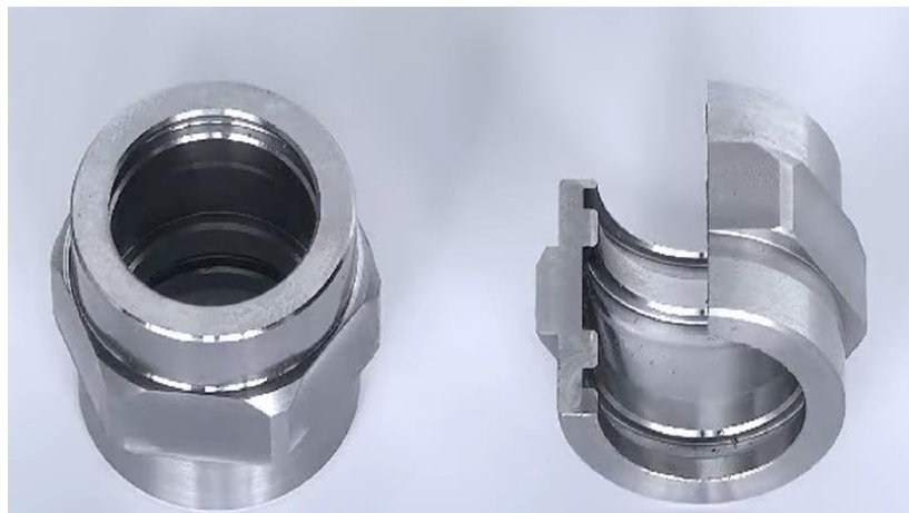
Slika 6.12 Proizvod izrađen višefunkcijskim alatom Iscar DRG-MF [41]
