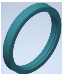
Slika 5.18; 3D model brtve klipnjače [autor - 21.04.2022.]
