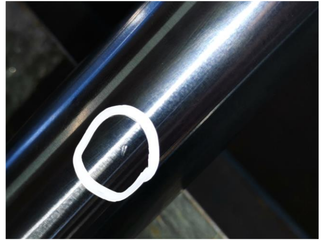
Slika 5.64; Naznačeno oštećenje klipnjače [autor - 19.05.2022.]
