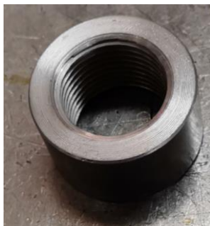
Slika 5.6; Zavareni priključak cilindra 1/2" [autor - 21.04.2022.]
