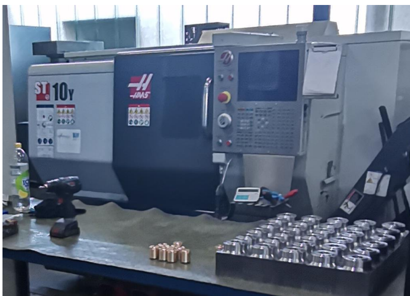
Slika 5.26; Tokarski obradni centar ST 10Y HAAS [autor - 21.04.2022.]
