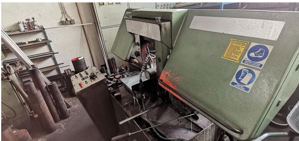
Slika 5.25; Horizontalna tračna pila HAP 280 [autor – 21.04.2022.]
