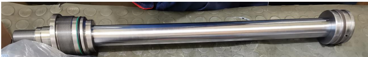
Slika 5.55; Klipnjača sa montiranim klipom i glavom cilindra, te pripadnim brtvama [autor - 19.05.2022.]
