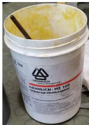
Slika 5.52; Specijalna mast za brtvene elemente [autor - 19.05.2022.]
