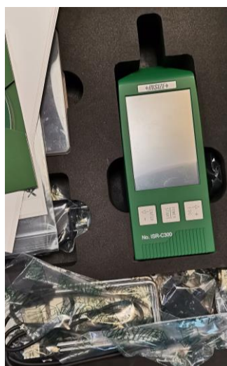
Slika 5.39; Uređaj za mjerenje hrapavosti INSIZE ISR-C300 [autor - 22.04.2022.]
