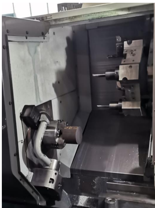
Slika 5.27; Stezanje sirovca glave cilindra [autor - 21.04.2022.]
