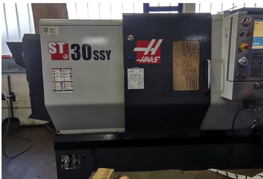
Slika 5.35; Tokarski obradni centar HAAS ST 30 SSY [autor - 21.04.2022.]
