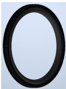
Slika 5.14; 3D model brtve klipa [autor - 21.04.2022.]
