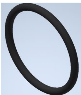
Slika 5.15; 3D model O-Ringa na klipu [autor - 21.04.2022.]
