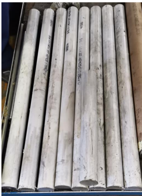
Slika 5.36; Standardne kromirane šipke promjera 45 mm [autor - 05.05.2022.]
