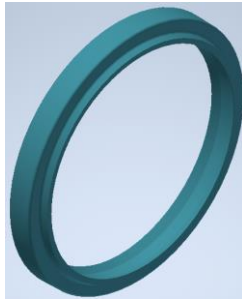
Slika 5.19; 3D model brisača [autor - 21.04.2022.]
