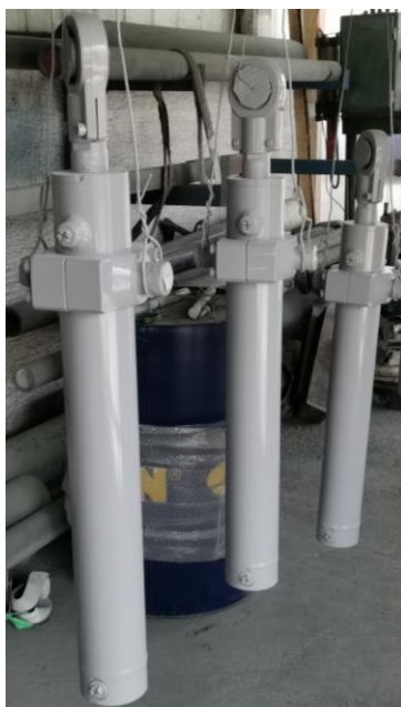
Slika 5.61; Sušenje cilindra nakon špricanja [autor - 26.05.2022.]
