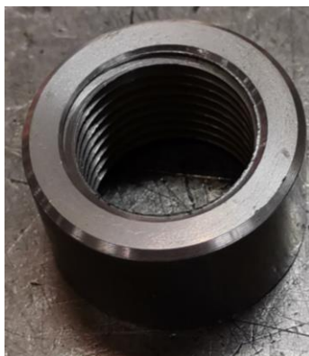
Slika 5.40; Priključak cilindra [autor - 21.04.2022.]
