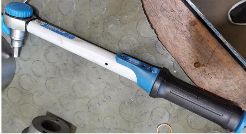
Slika 5.57; Moment ključ s mogućnošću podešavanja zatezne sile [autor - 19.05.2022.]
