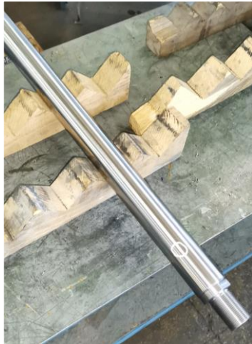
Slika 5.63; Oštećenje klipnjače [autor - 19.05.2022.]
