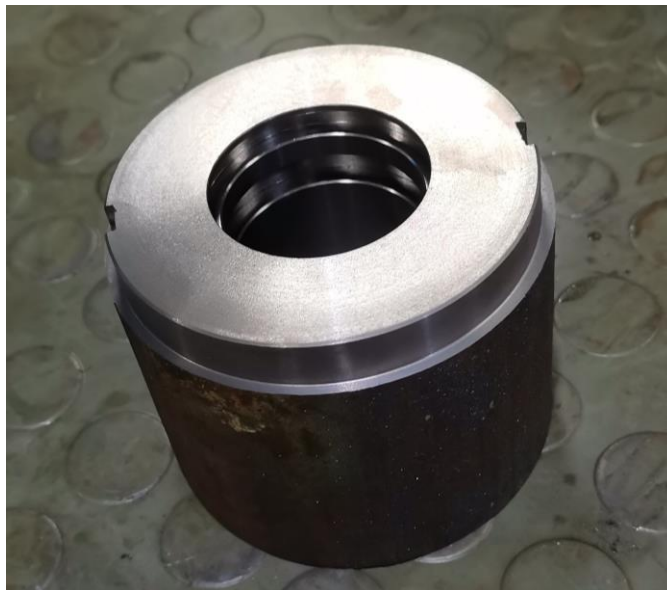
Slika 5.28; Obrada glave cilindra u jednom stezanju [autor - 22.04.2022.]
