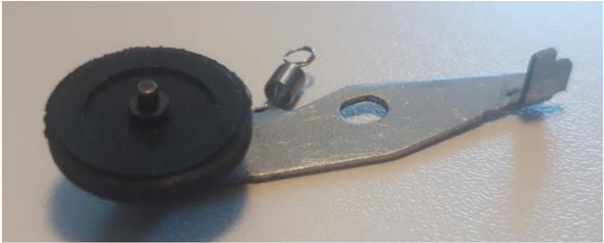
Slika 68 Brtva ugrađena na pripadajući kotačić, fotografirano 13.5.2022.
