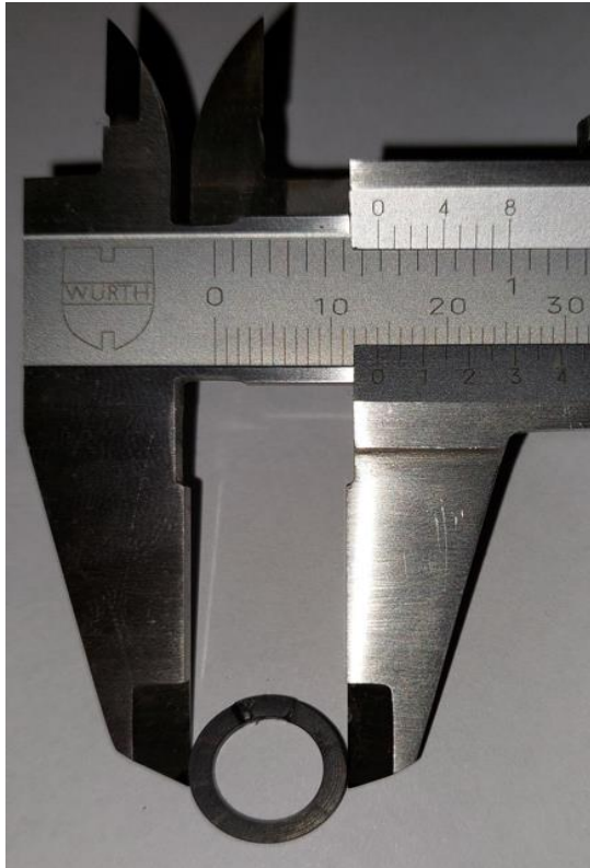
Slika 2 Mjerenje vanjskog promjera brtve, fotografirano 29.4.2022.
