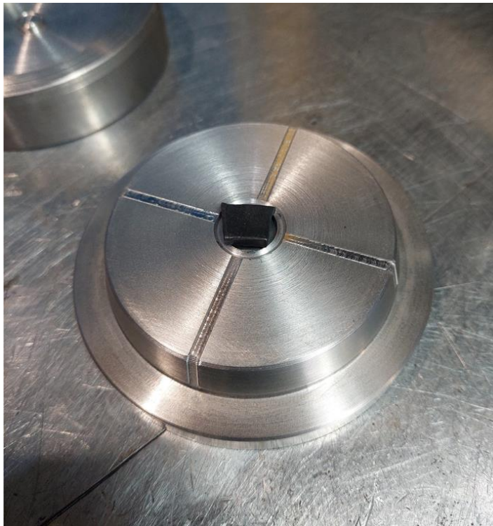
Slika 64 Prikaz ručnog punjenja kalupne šupljine, fotografirano 9.5.2022.
