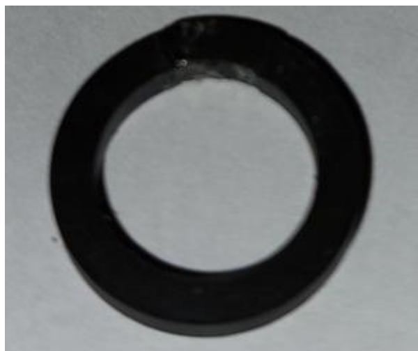
Slika 1 Oštećena brtva, fotografirano 29.4.2022.
