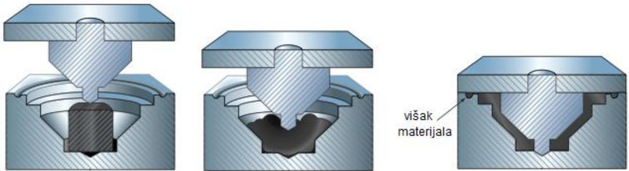
*Slika 11 Koncept kompresijskog kalupa[8]*
