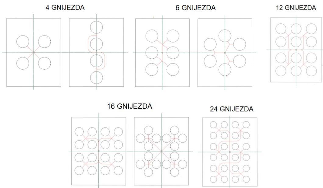
Slika 43 Preporuke za raspored gnijezda u injekcijskom kalupu[6]
