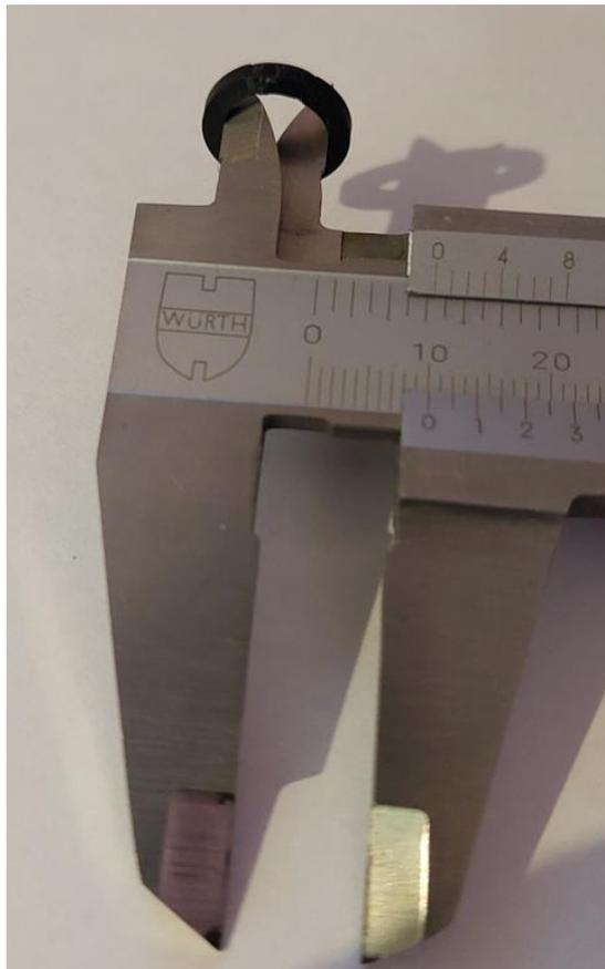
*Slika 3 Mjerenje unutarnjeg promjera brtve, fotografirano 29.4.2022.*
