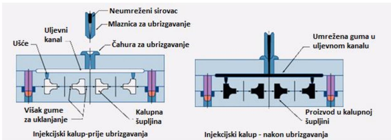
Slika 15 Koncept injekcijskog kalupa[9]
