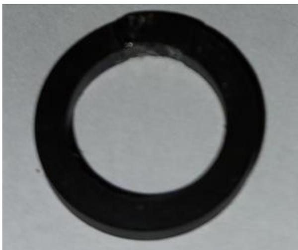
*Slika 1 Oštećena brtva, fotografirano 29.4.2022.*
