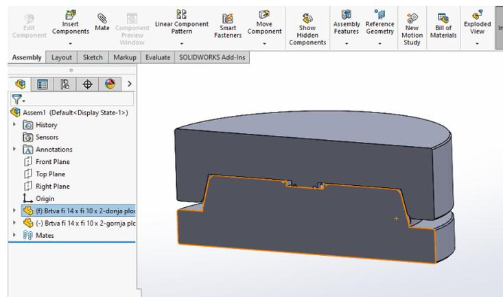
*Slika 42 Sklop donje i gornje ploče kalupa u presjeku*
