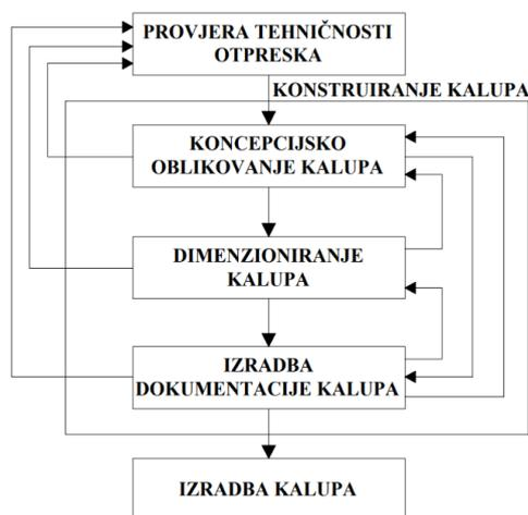
Slika 24 Algoritam za konstrukciju kalupa[1]
