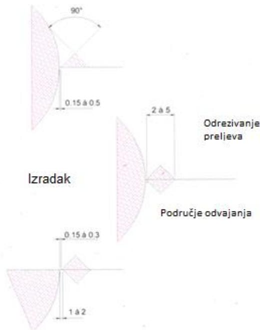
Slika 13 Izvedba kanala za višak gume[6]
