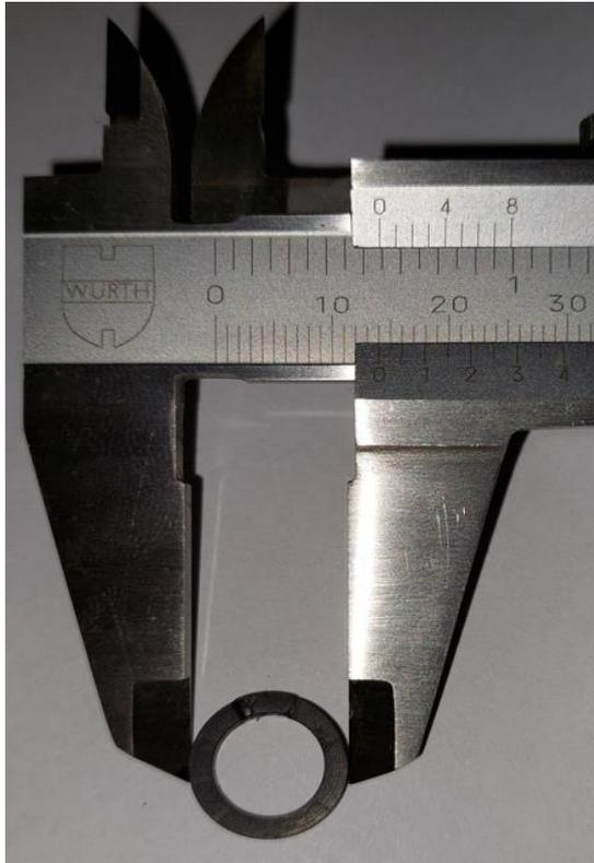
*Slika 2 Mjerenje vanjskog promjera brtve, fotografirano 29.4.2022.*
