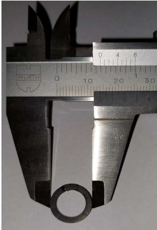
Slika 2 Mjerenje vanjskog promjera brtve, fotografirano 29.4.2022.
