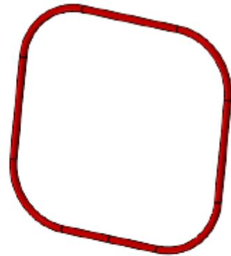
Napomena: Brtva se izrađuje lijepljenjem iz ekstrudiranog profila  $\varnothing 7.2$ , razvijena dužina je 803,3 mm.
