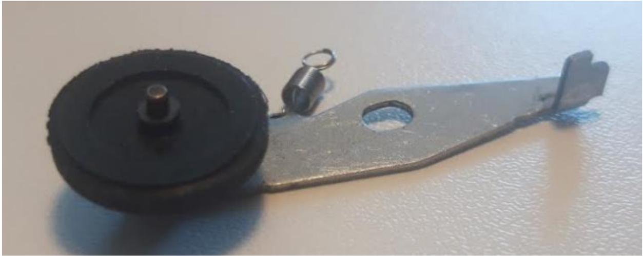
*Slika 68 Brtva ugrađena na pripadajući kotačić, fotografirano 13.5.2022.*
