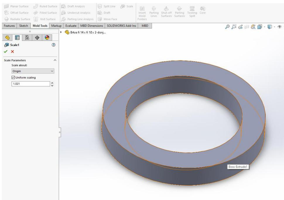
Slika 29 Funkcija Scale - uvećanje dimenzija proizvoda
