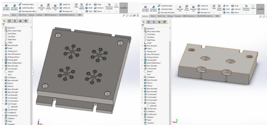
*Slika 59 Prikaz kompletnog uljevnog sustava gornje ploče*
