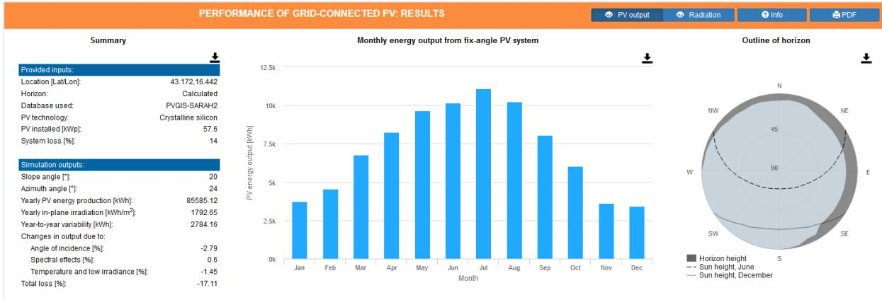
**Slika 3.9;** Prikaz proizvodnje sunčane elektrane pomoću alata PVGIS [44]
