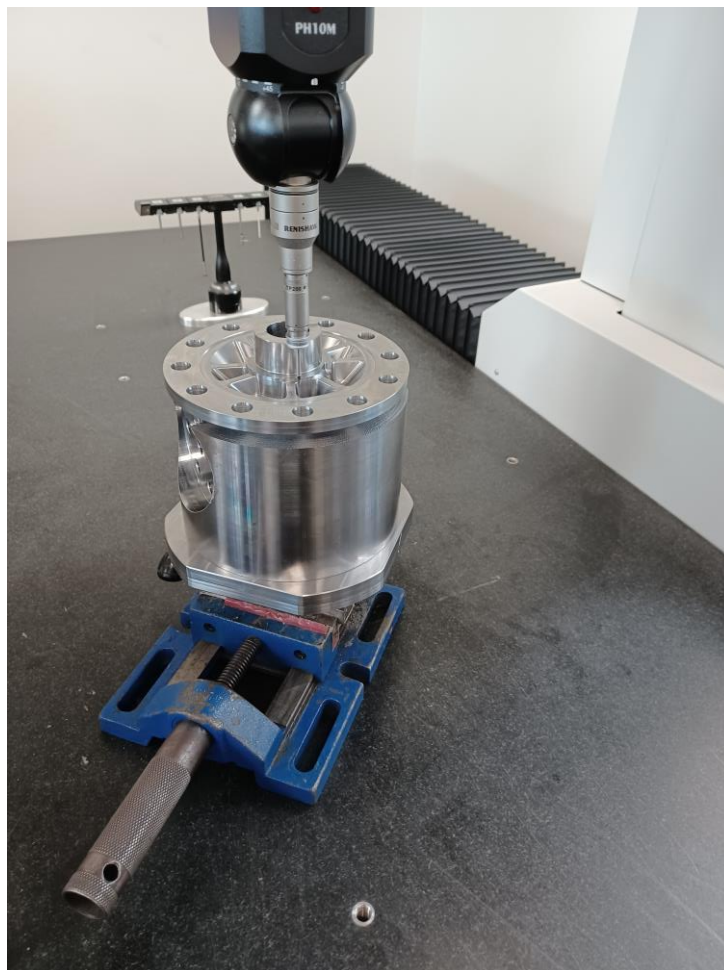
Slika 3.10: Mjerenje pozicije na mjernom uređaju Wenzel [Varaždinske Toplice, srpanj 2022.]
