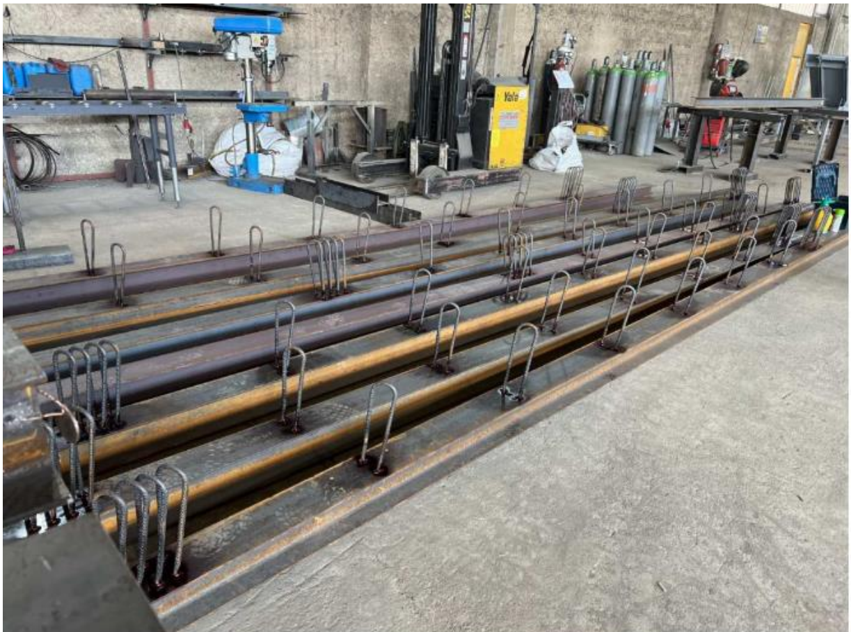
Slika 5.1 Dijelovi zaštitne ograde autoceste
