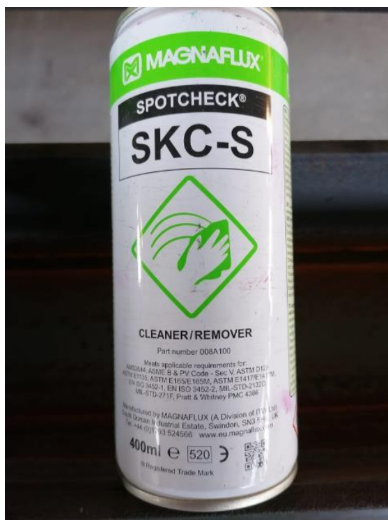
Slika 5.8 Čistač viška penetranta
