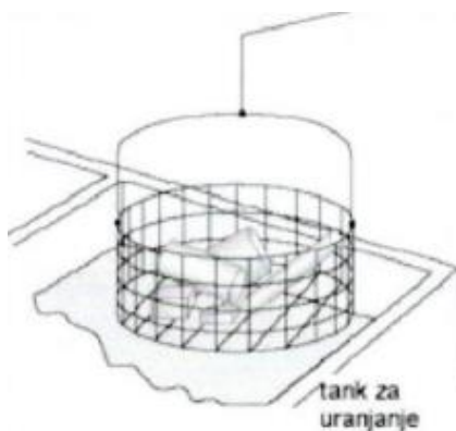
Slika 4.21 Nanašanje mokrog razvijača na vodenoj osnovi [10]
