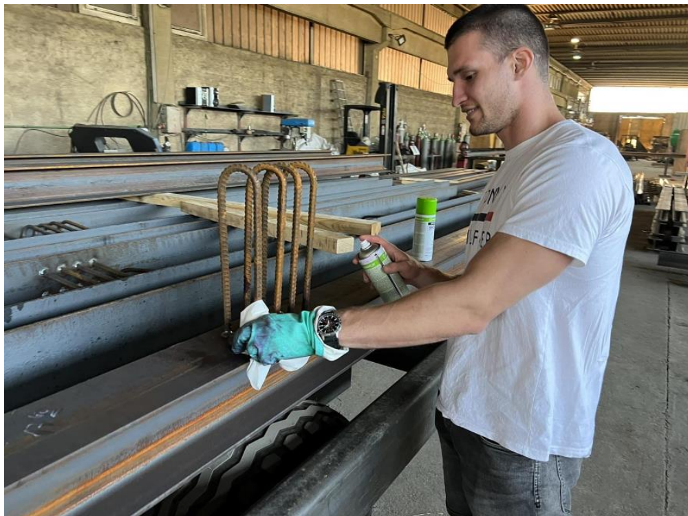
Slika 5.9 Uklanjanje viška penetranta uz pomoć krpe i čistača
