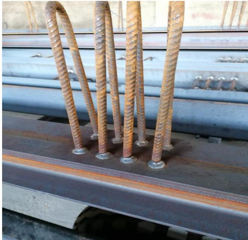
Slika 5.4 Očišćene i osušene površine zavarenog spoja
