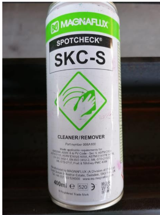
Slika 5.8 Čistač viška penetranta
