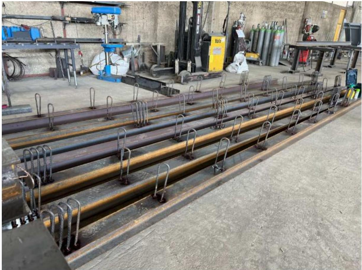
Slika 5.1 Dijelovi zaštitne ograde autoceste
