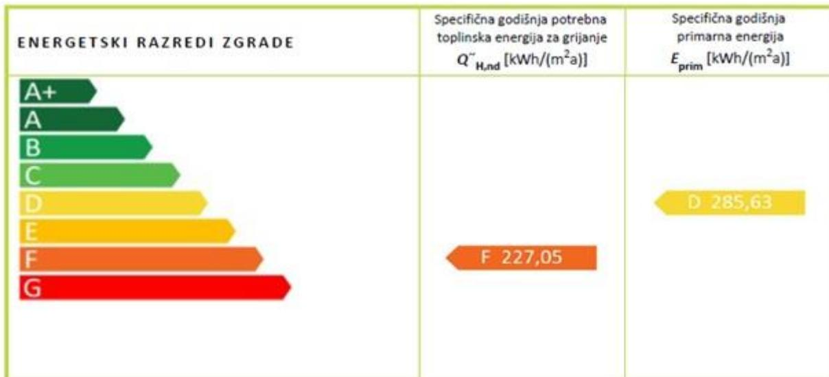
Slika 15 - Prikaz energetskog certifikata nakon provedene mjere 1
