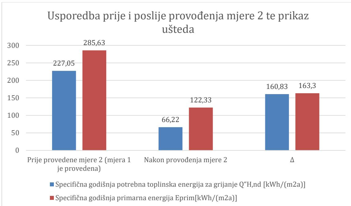
Tablica 14 – Usporedba prije i poslije provođenja mjere 2(uključujući i mjeru 1) te prikaz ušteda prema stvarnim klimatskim podacima
