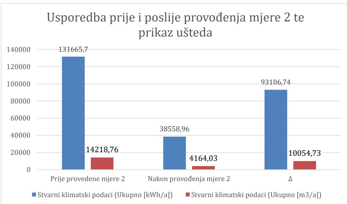
Prema prikazanom grafu godišnja ušteda prilikom implementacije mjere 2 uzimajući u obzir podatke nakon implementirane mjeru 1 prema stvarnim klimatskim podacima
