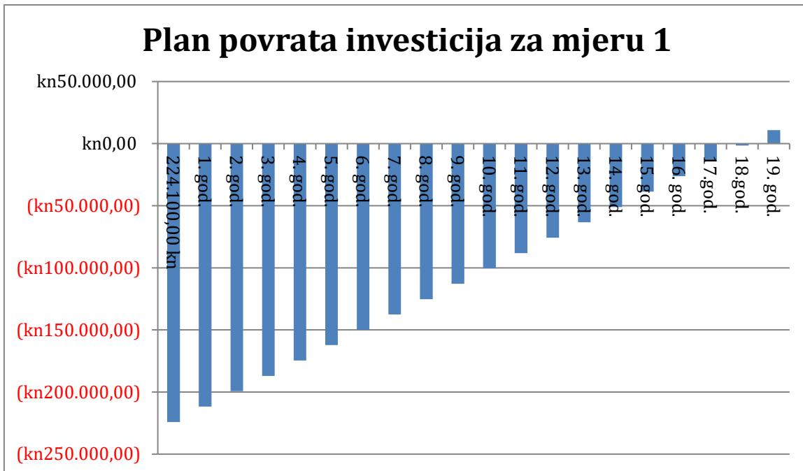
Prema prikazanom planu povrata investicije mjere 1 odnosno zamjene postojeće drvene stolarije novom PVC stolarijom sa trostruko izolirajućim staklima s dva stakla niske emisije (dvije Low-E obloge) isplatila bi se za **19 godina**.
