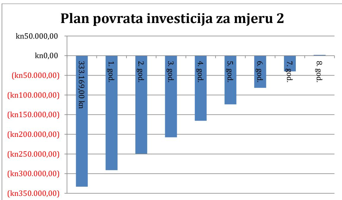
Prema prikazanom planu povrata investicija mjera 2 odnosno ugradnja toplinske izolacije na strop SV, vanjski zid VZ1 i strop podruma PN 1 isplatila bi se za **8 godina**.
