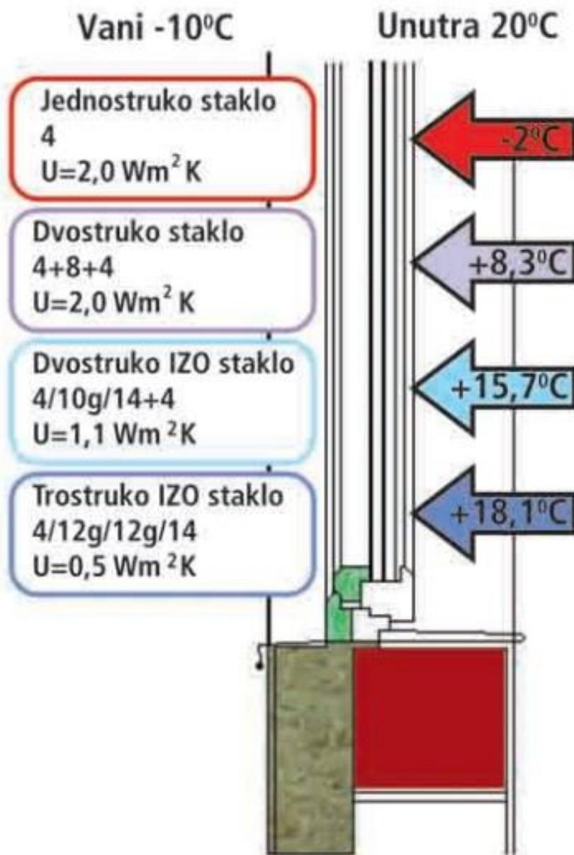
Slika 7 – usporedba kvalitete stakla na području toplinske ugodnosti i uštede energije [18]
