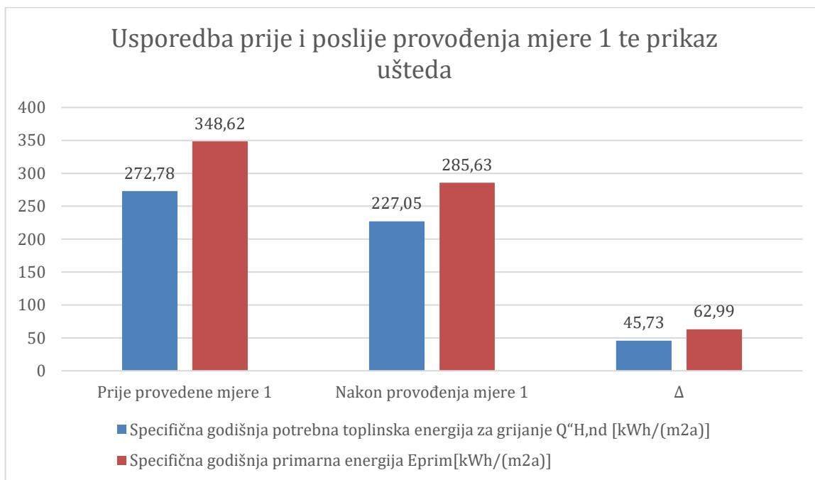
Tablica 8 – Usporedba prije i poslije provođenja mjere 1 te prikaz ušteda prema stvarnim klimatskim podacima
