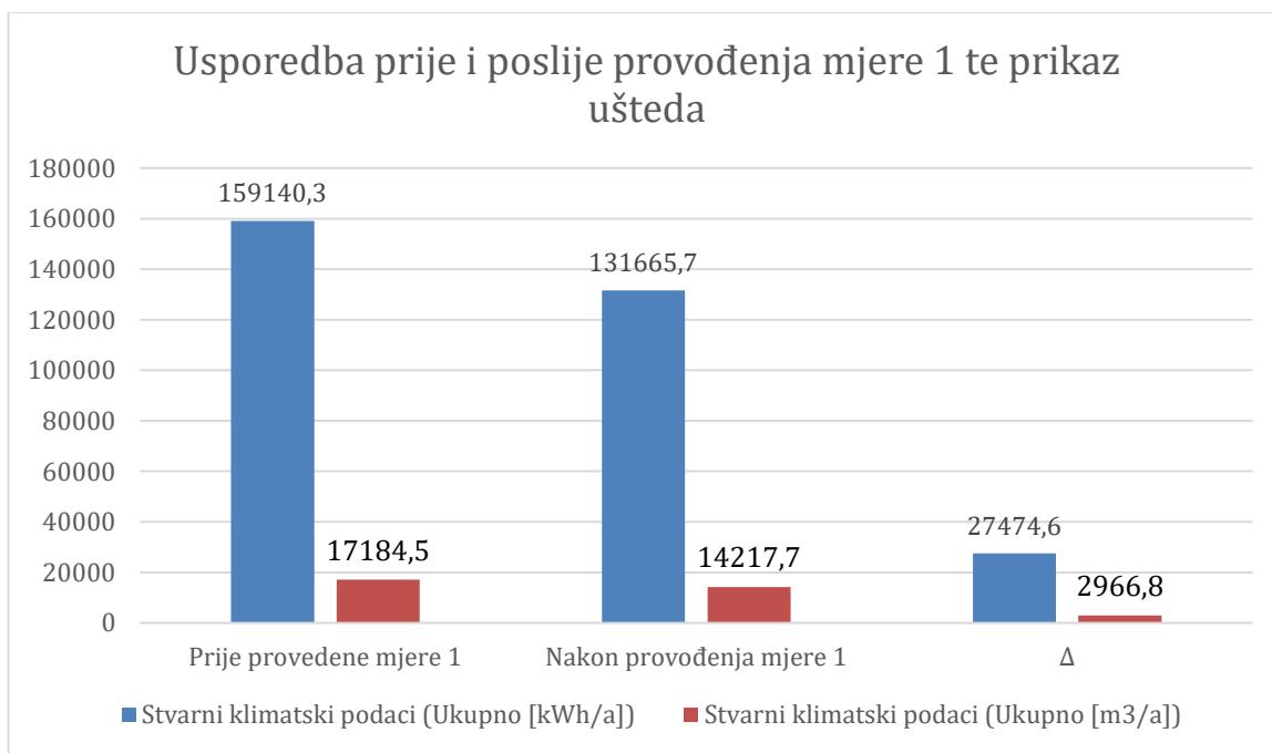
Prema prikazanom grafu godišnja ušteda prilikom implementacije mјere 1 prema stvarnim klimatskim podacima je  $\Delta = 27474,6 \text{ kWh/a}$  i uz jediničnu cijenu plina **0,45 kn/kWh** ušteda iznosi **12363,57 kn**.
