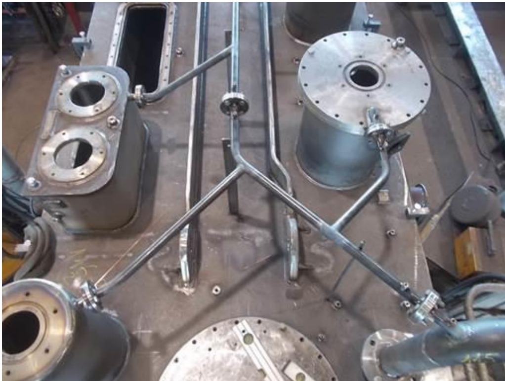
Slika 5.5. Probna montaža kotla D&ST[19]
