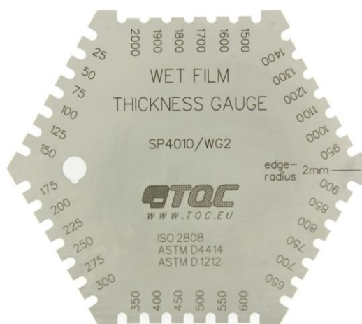
Slika 5.6. Češalj za mjerenje mokrog filma [29]
