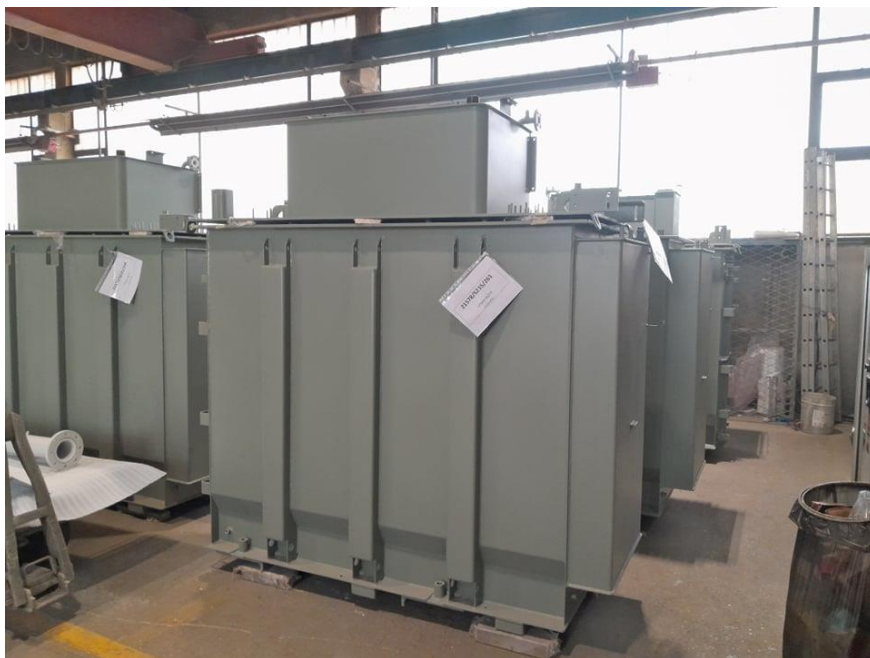
Slika 2.5. Završni proizvod SBG transformatorski kotao [ 19]
