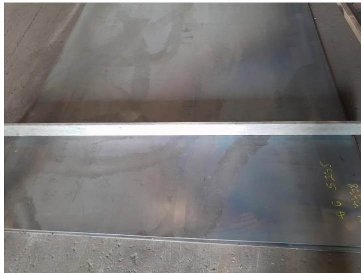
Slika 5.1. Ulazna kontrola ravnosti i dimenzija pristiglog lima[19]
