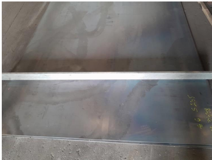
Slika 5.1. Ulazna kontrola ravnosti i dimenzija pristiglog lima[19]
