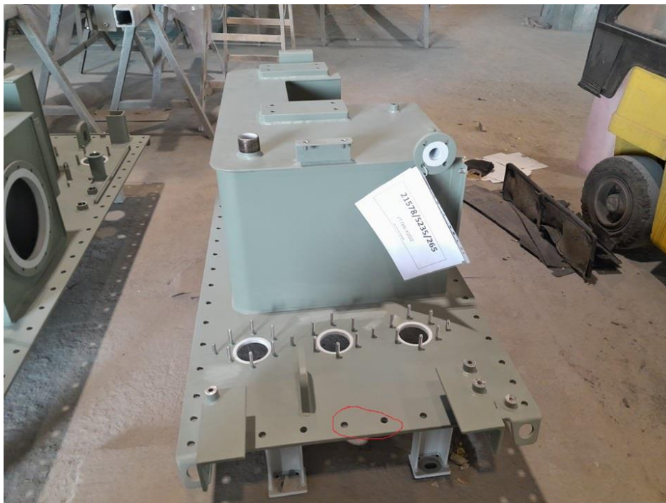
Slika 5.8 Nesukladnost na SBG Siemens poklopcu [19]
