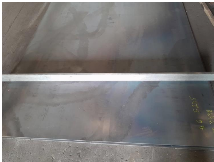
Slika 5.1. Ulazna kontrola ravnosti i dimenzija pristiglog lima[19]
