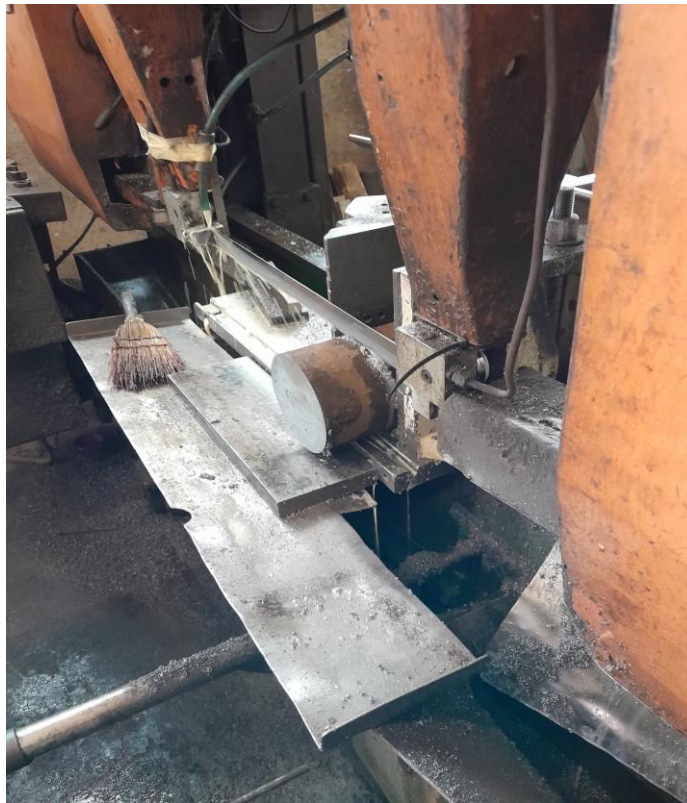
Slika 4.2 Rezanje na pili[19]
