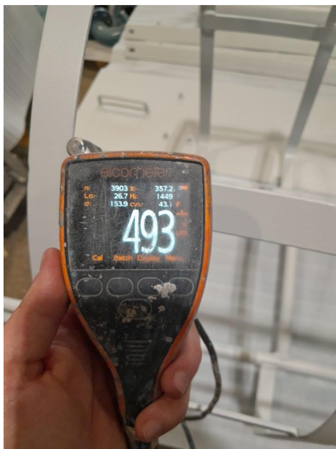
Slika 2.4. Kontrola nanosa antikorozivne zaštite [19]
