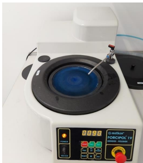
Slika 5.16 Brusilica Forcipol IV, marke Metkon
