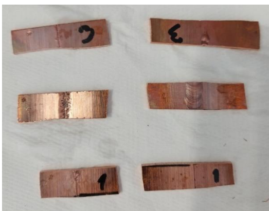
Slika 5.15 Izrezani uzorci za makro izbrusak
