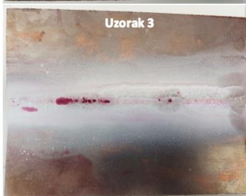
Slika 5.13 Rezultati ispitivanja penetrantima
