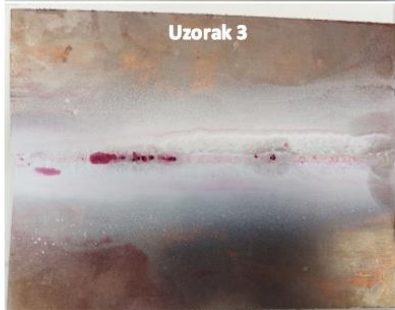
Slika 5.13 Rezultati ispitivanja penetrantima
